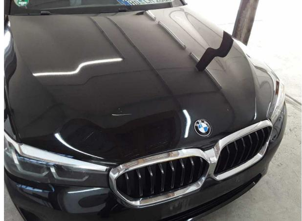
**Beschädigung #4:** Motorhaube: Motorhaube - verkratzt / verschürft - lackieren
