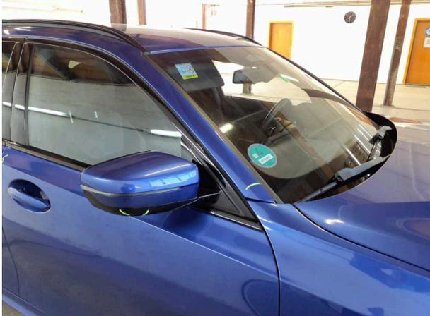
**Beschädigung #6:** Fahrzeugdach: Dachholm rechts - Kratzer - auslegen / polieren
