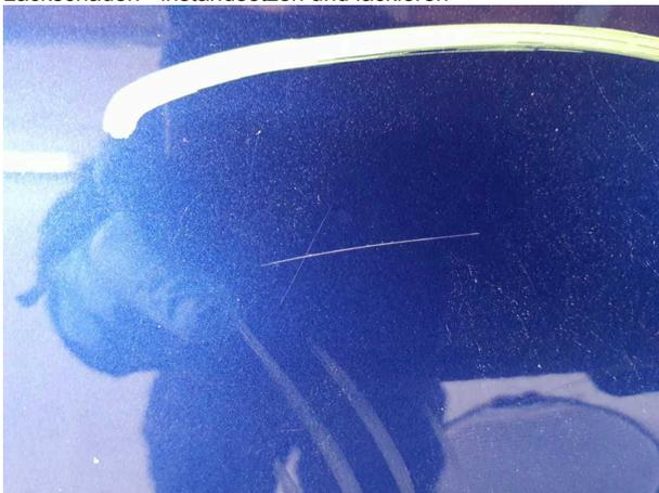
**Beschädigung #25:** Seitenwand rechts: Seitenwand - Kratzer - lackieren
