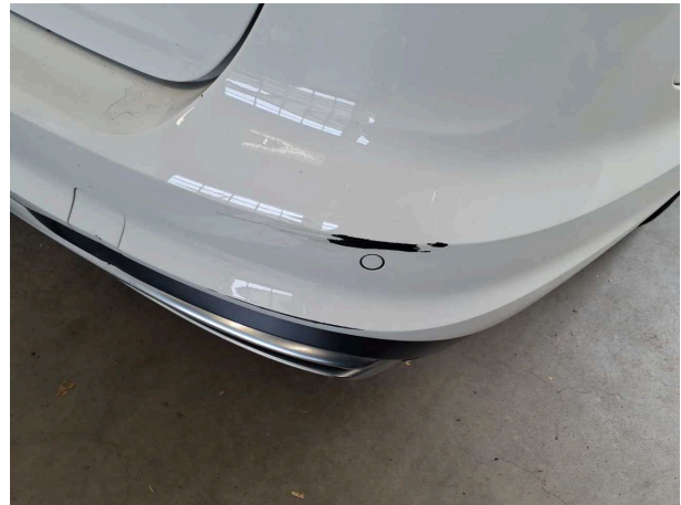
Damage #7: Rear bumper: Rear bumper (Leichte Verformung, schadenserweiterung möglich) - Scratched - Repair and paint
