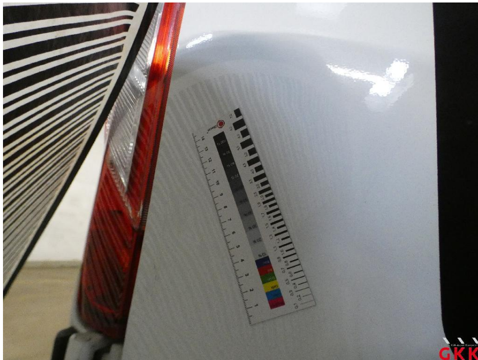
Bild 20 Hecktür links, beschädigt, instand setzen - lackieren
