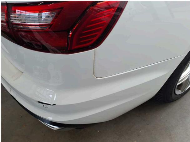
**Beschädigung #7:** Stossfänger hinten: Stossfänger hinten (Leichte Verformung, schadenserweiterung möglich) - verkratzt / verschürft -
