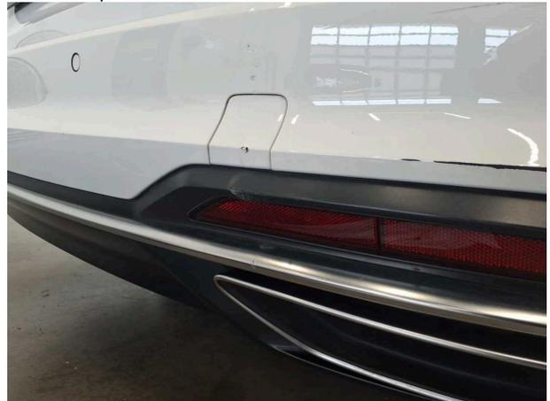
**Beschädigung #4:** Stossfänger hinten: Spoiler - verformt -
