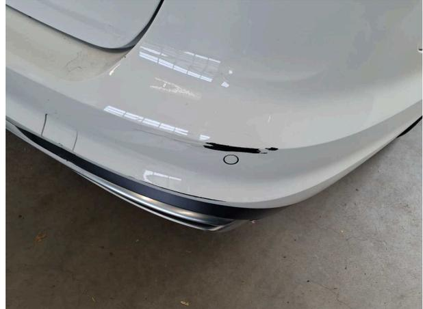
**Beschädigung #7:** Stossfänger hinten: Stossfänger hinten (Leichte Verformung, schadenserweiterung möglich) -
