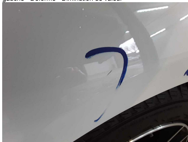
Domage #2: Panneau latéral arrière gauche: Paroi latérale - Eraflé - Réparer et repeindre
