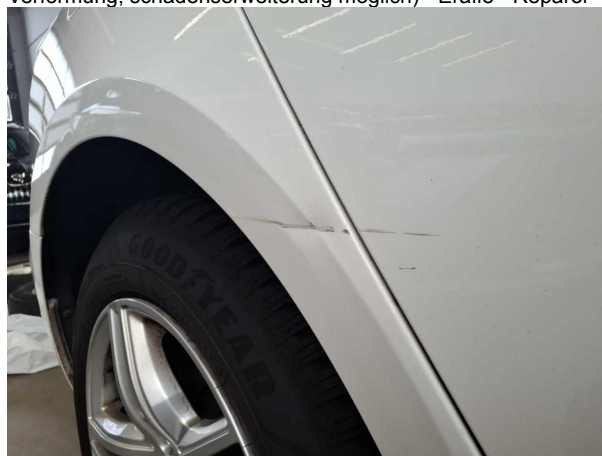
Dommage #8: Panneau latéral arrière droit: Paroi latérale - Eraflé - Réparer et repeindre
