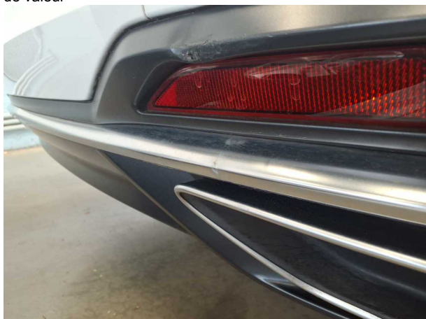
Dommage #3: Pare-chocs arrière: Barrette de protection milieu - Eraflé - Remplacer
