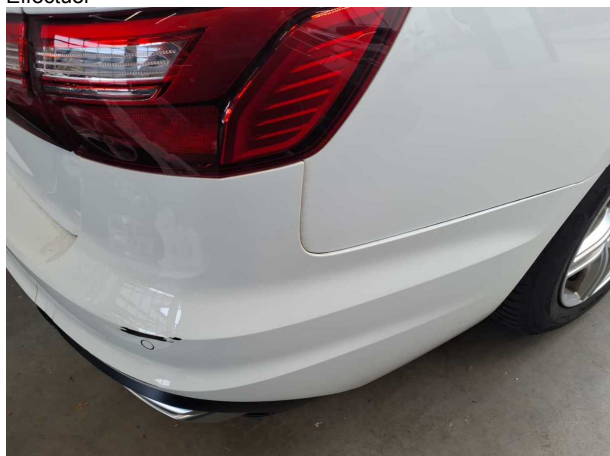
Dommage #7: Pare-chocs arrière: Pare-chocs arrière (Leichte Verformung, schadenserweiterung möglich) - Eraflé - Réparer et
