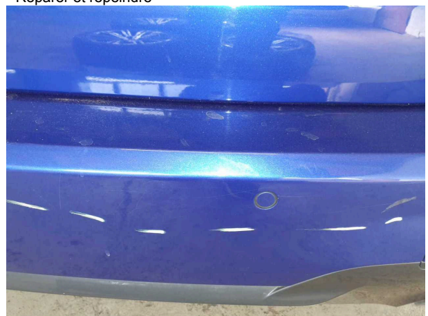
Domage #20: Pare-chocs arrière: Pare-chocs arrière - Erafilé - Réparer et repeindre
