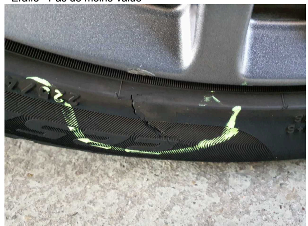
Domage #5: Roue / Pneumatiques: Pneumatique avant droit - Dommages - Pas de moins-value
