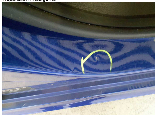
Domage #14: Seuil droit: Accès - Bosse, dommage peintur... Réparation intelligente
