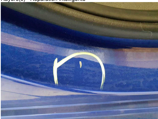
Domage #14: Seuil droit: Accès - Bosse, dommage peinture - Réparation intelligente
