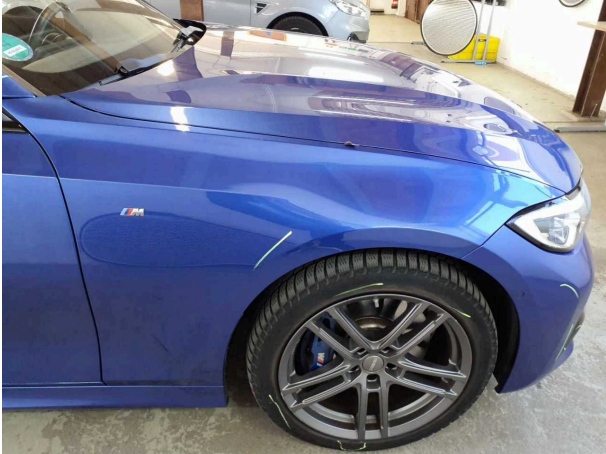
Domage #19: Garde-boue droit: Garde-boue droit - Rayure(s) - Peinture
