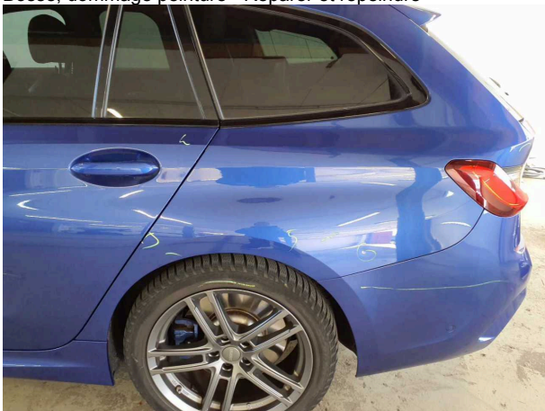
Domage #24: Panneau latéral arrière gauche: Paroi latérale - Bosse, dommage peinture - Réparer et repeindre
