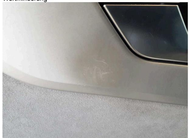
**Beschädigung #4:** Verkleidungen/Abdeckungen: Zierleiste / Dekorleiste (türverkleidung VL) - verkratzt / verschürft -
