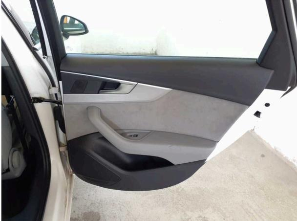
**Beschädigung #5:** Verkleidungen/Abdeckungen: Türverkleidung hinten rechts - verformt - Wertminderung
