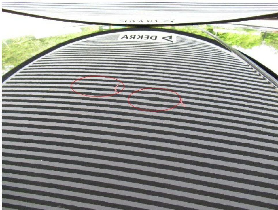
Bild 22 : Hagel-Umweltschaden an Dach und Heckdeckel
