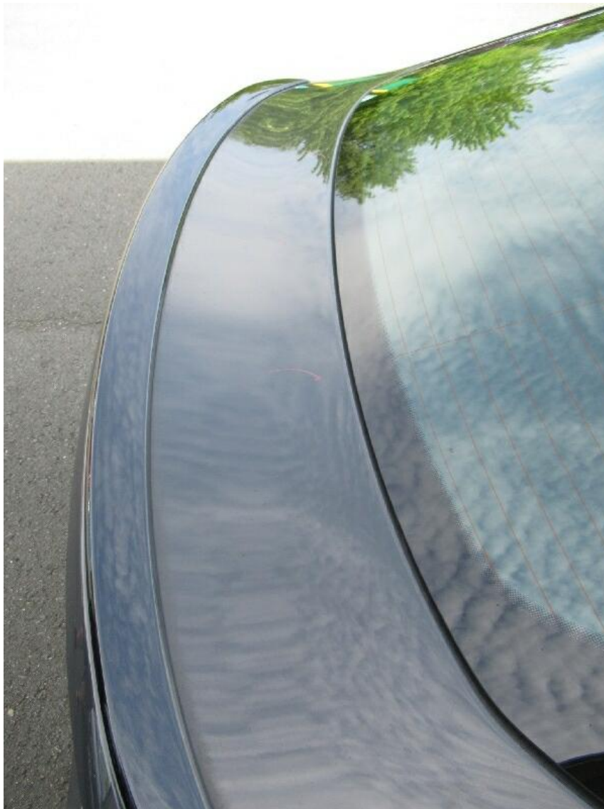
Bild 24 : Hagel-Umweltschaden an Dach und Heckdeckel
