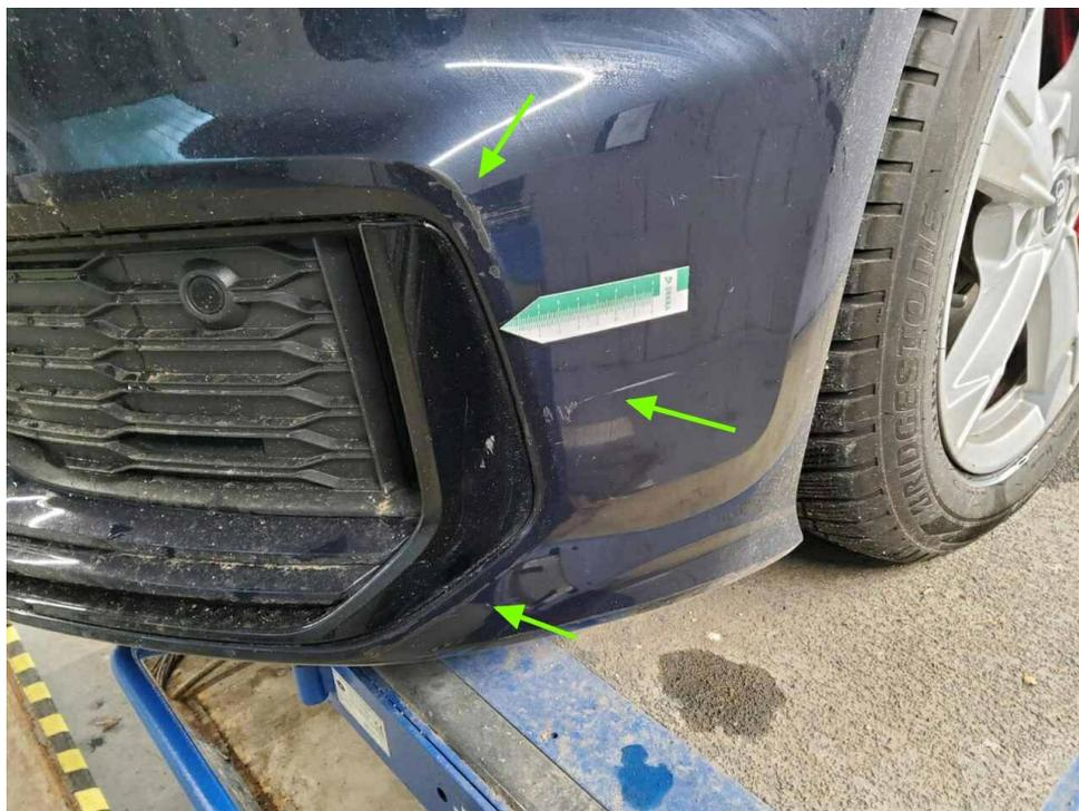
Bild 14 : Stoßfänger vorne Lackierung, verschrammt, lackieren mit Lackaufbau
