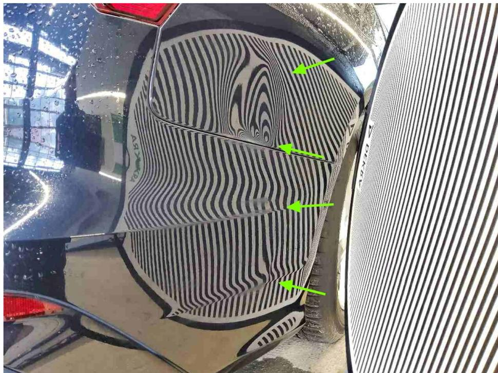
Bild 17 : Aktueller Schaden hinten rechts
