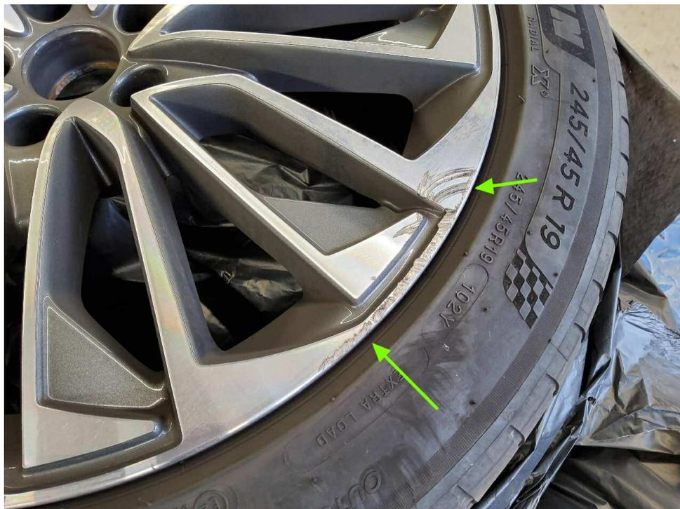
Bild 23 : Sommeralufelge hinten rechts verschrammt (glanzgedreht)
