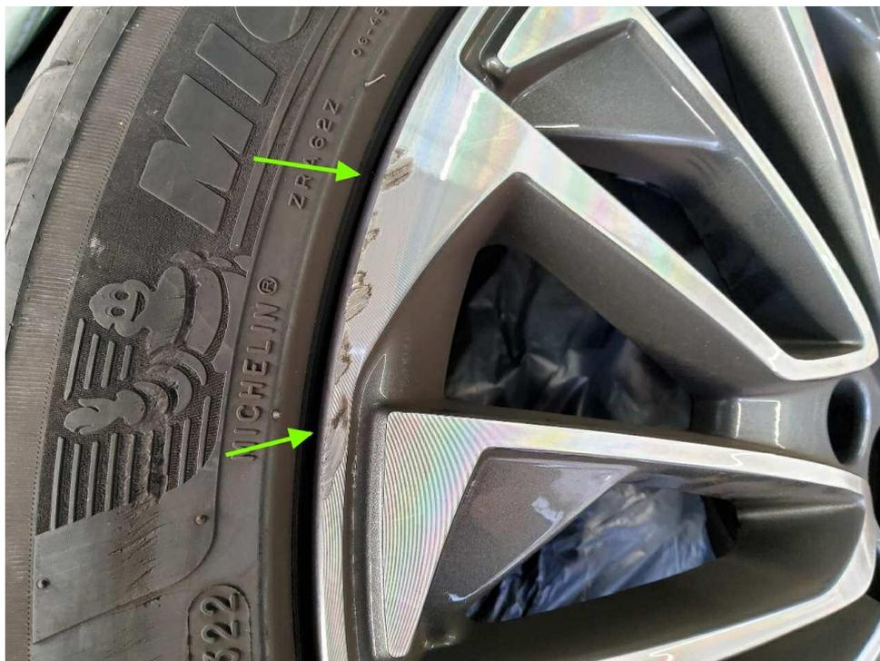
Bild 22 : Sommeralufelge vorne rechts verschrammt (glanzgedreht)
