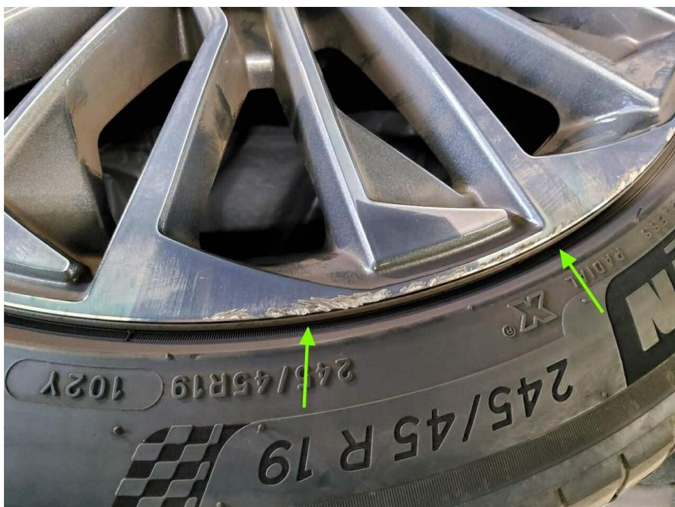
Bild 24 : Sommeralufelge vorne links verschrammt (glanzgedreht)
