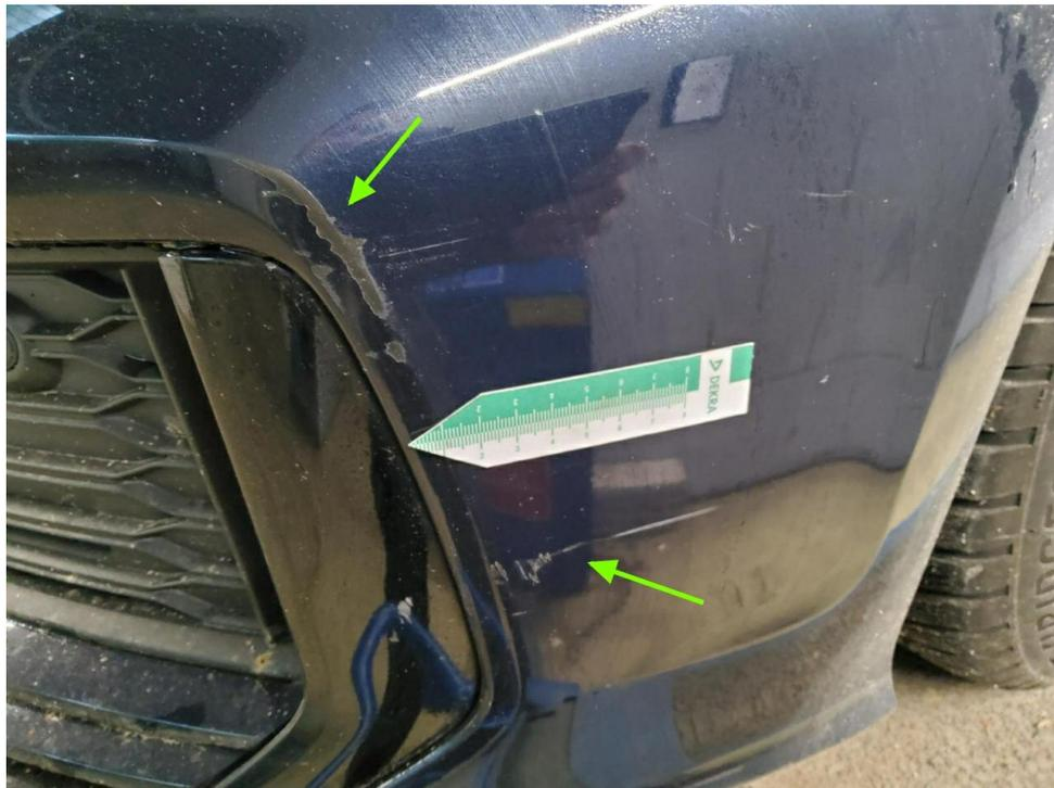
Bild 15 : Stoßfänger vorne Lackierung, verschrammt, lackieren mit Lackaufbau
