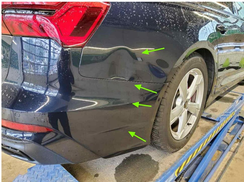
Bild 16 : Aktueller Schaden hinten rechts
