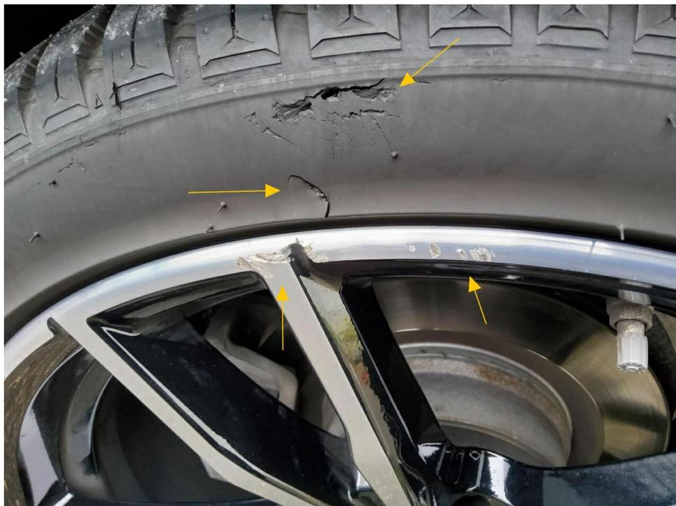
Bild 11 : Felge hinten links, verschrammt, erneuern
