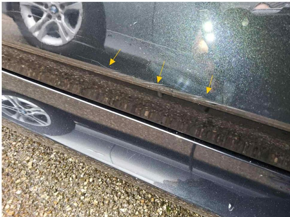
Bild 13 : Tür vorne links Lackierung, zerkratzt, polieren
