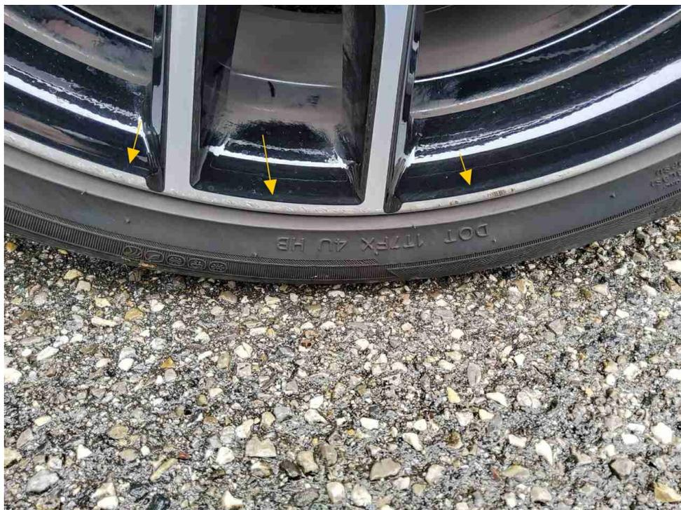
Bild 8 : Felge vorne rechts, verschrammt, erneuern
