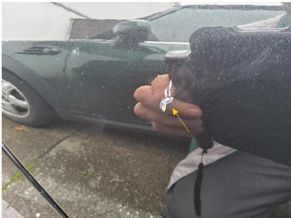
Bild 10 : Tür hinten rechts Lackierung, zerkratzt, polieren
