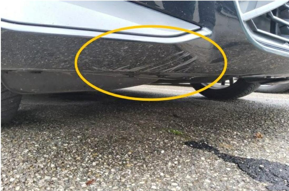
Bild 7 : Stoßfänger vorne Lackierung, verschrammt, smart repair
