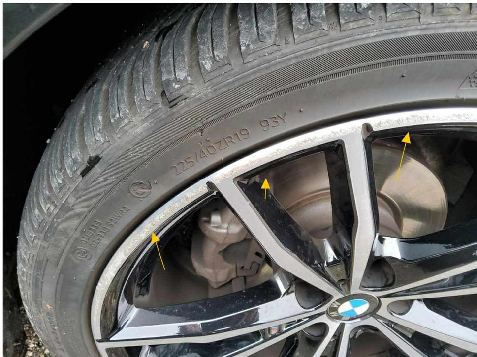
Bild 9 : Felge vorne rechts, verschrammt, erneuern
