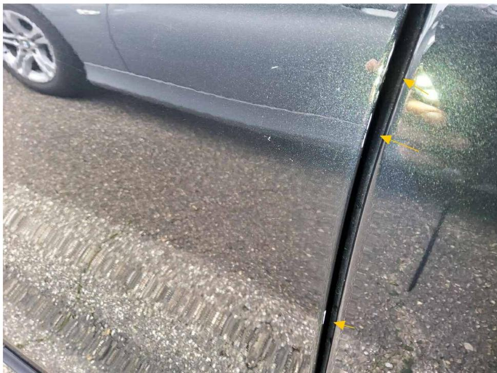
Bild 12 : Tür vorne links Türkante, zerkratzt, Gebrauchsspur
