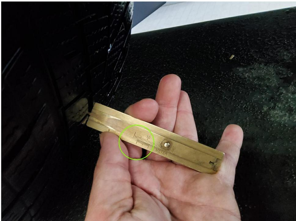
Bild 42 : Winterreifen hinten links unter 4mm Profil
