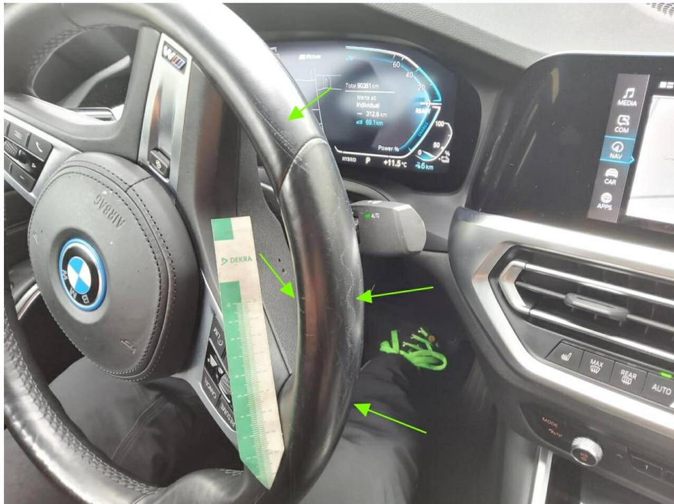
Bild 45 : Lenkrad zerkratzt
