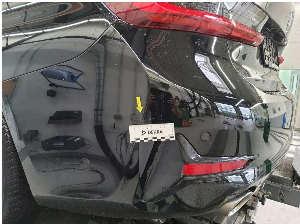
Bild 20 : Stoßfänger hinten zerkratzt im Sensorbereich, Mitte
