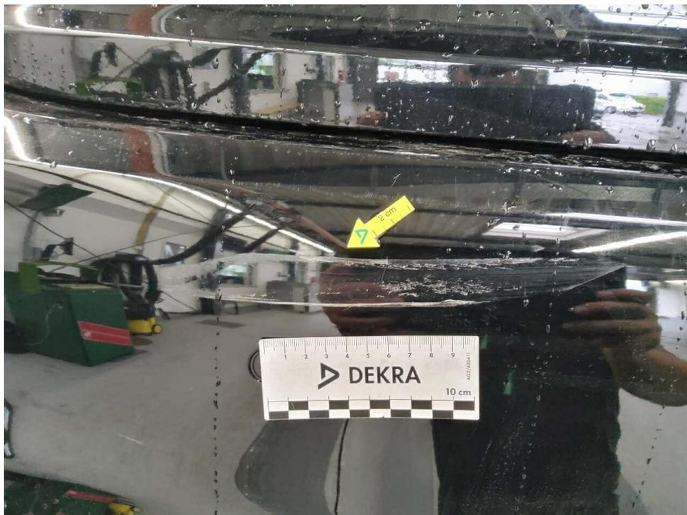
Bild 23 : Stoßfänger hinten zerkratzt im Sensorbereich, Mitte
