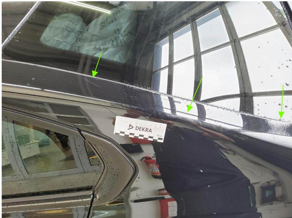
Bild 27 : Seitenteil hinten links Lackierung, zerkratzt, lackieren
