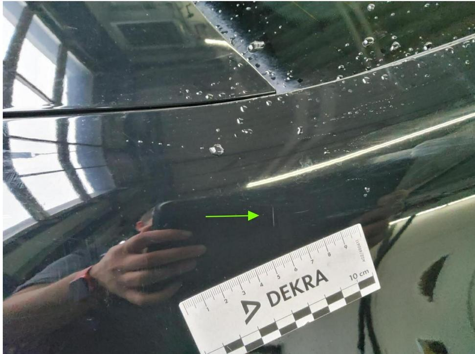
Bild 25 : Seitenteil hinten rechts Lackierung, zerkratzt, lackieren
