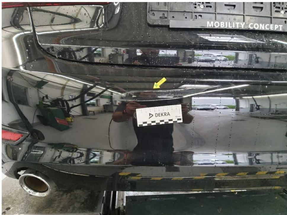
Bild 22 : Stoßfänger hinten zerkratzt im Sensorbereich, Mitte
