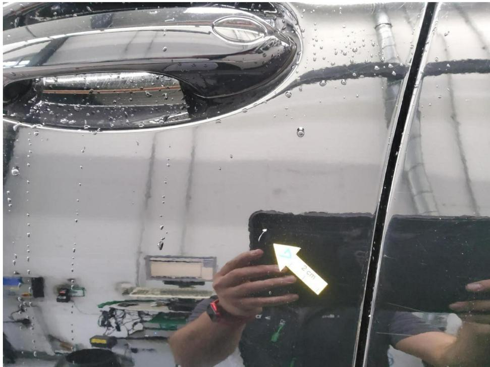
Bild 37 : Tür vorne links, mehrfach eingedellt, instandsetzen und lackieren mit Lackaufbau
