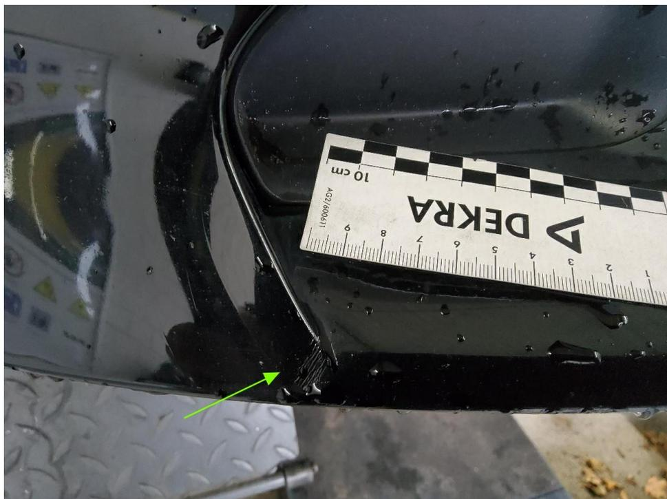
Bild 18 : Stoßfänger vorne verformt und zerkratzt, Blende Nebelscheinwerfer rechts zerkratzt
