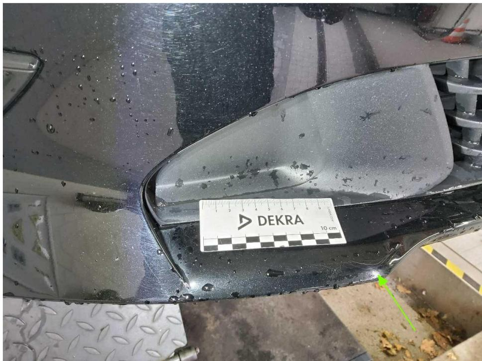
Bild 17 : Stoßfänger vorne verformt und zerkratzt, Blende Nebelscheinwerfer rechts zerkratzt
