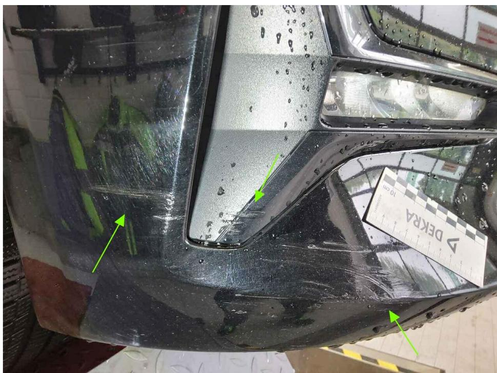
Bild 16 : Stoßfänger vorne verformt und zerkratzt, Blende Nebelscheinwerfer rechts zerkratzt
