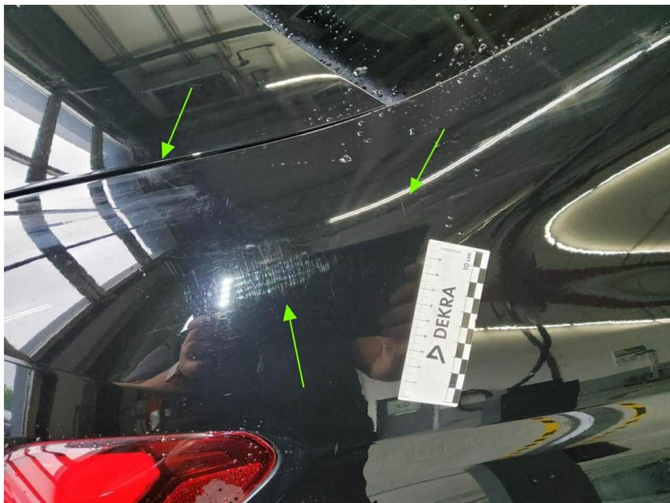
Bild 24 : Seitenteil hinten rechts Lackierung, zerkratzt, lackieren
