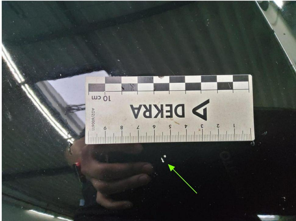
Bild 33 : Motorhaube Lackierung, zerkratzt, lackieren
