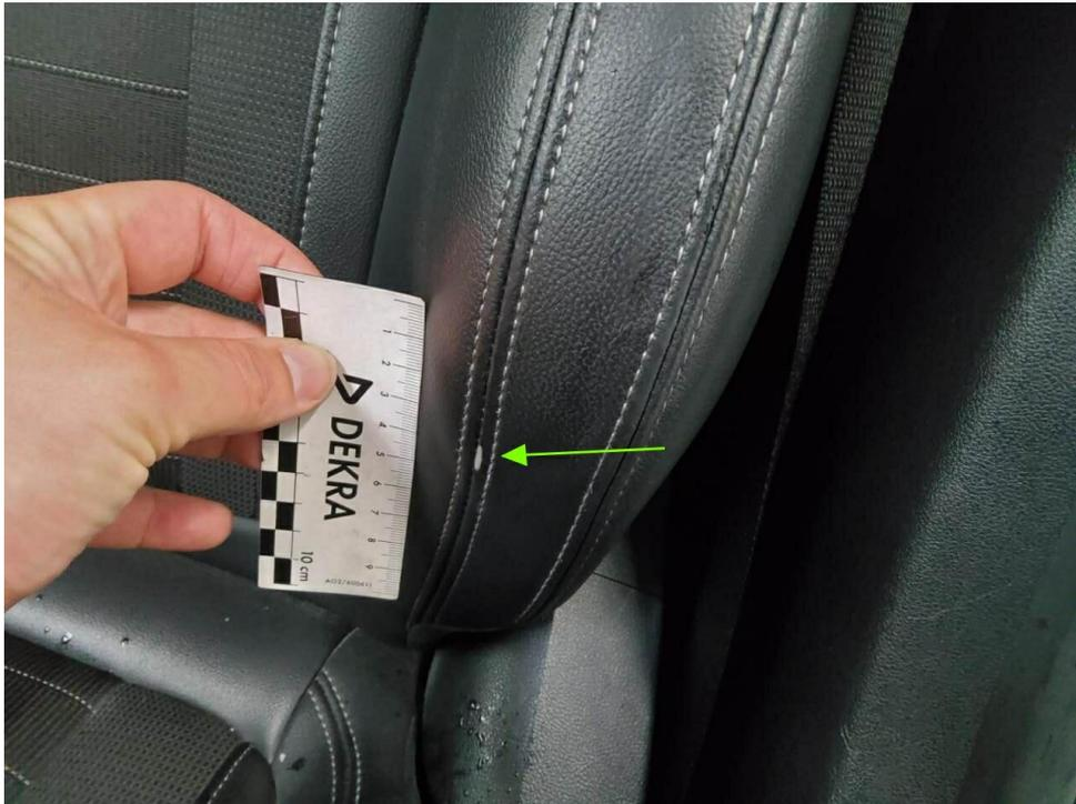
Bild 47 : Sitz vorne links Sitzlehnenbezug, zerkratzt, smart repair
