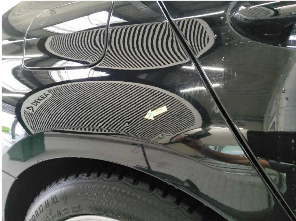
Bild 39 : Seitenteil hinten rechts, eingedellt, drücken
