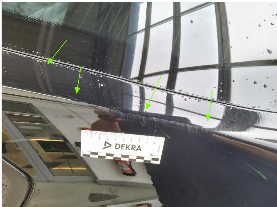
Bild 29 : Seitenteil hinten links Lackierung, zerkratzt, lackieren
