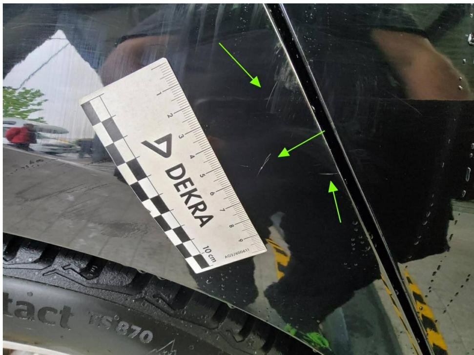
Bild 26 : Seitenteil hinten rechts Lackierung, zerkratzt, lackieren
