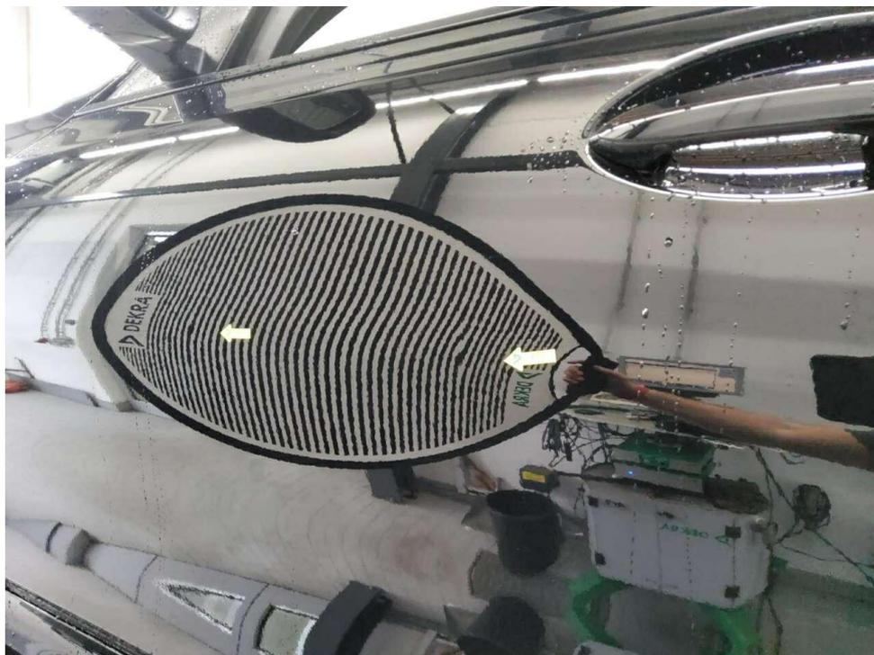
Bild 36 : Tür vorne links, mehrfach eingedellt, instandsetzen und lackieren mit Lackaufbau
