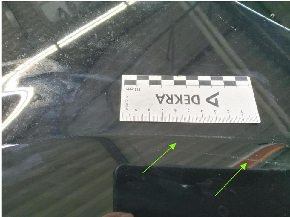
Bild 31 : Motorhaube Lackierung, zerkratzt, lackieren
