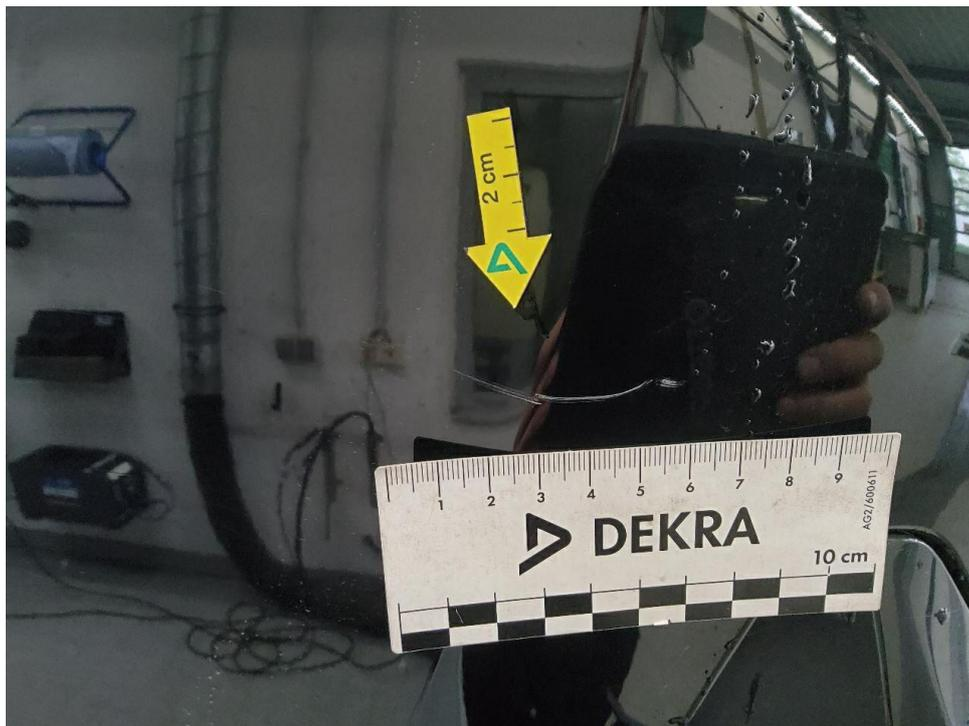
Bild 21 : Stoßfänger hinten zerkratzt im Sensorbereich, Mitte
