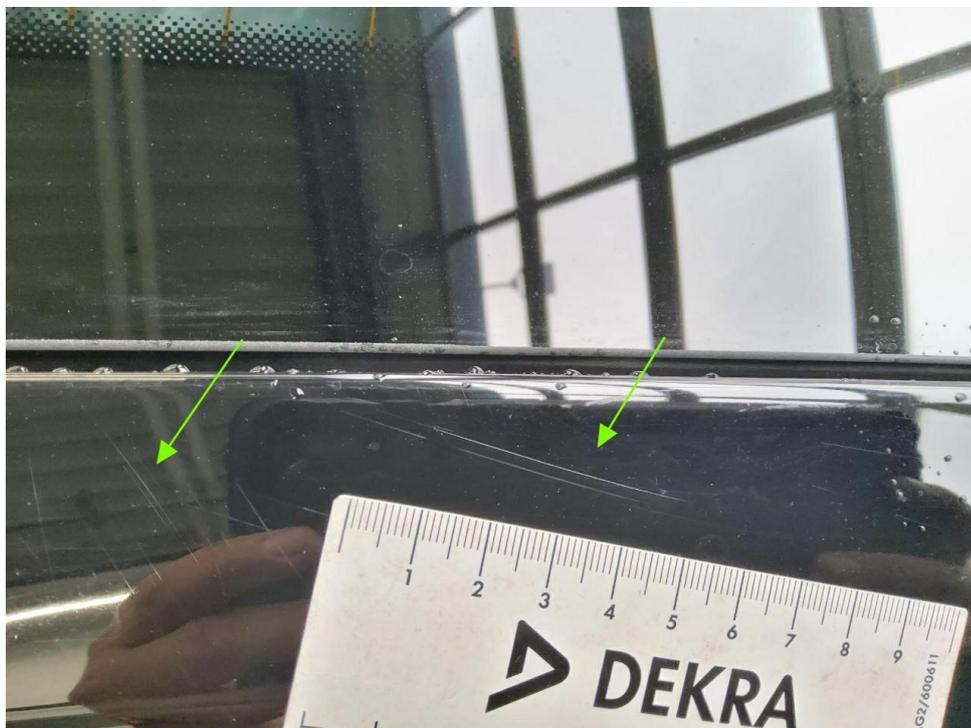
Bild 28 : Seitenteil hinten links Lackierung, zerkratzt, lackieren
