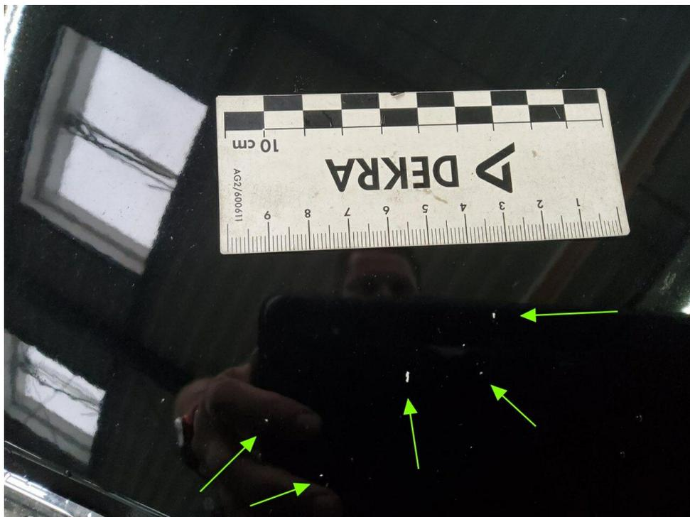
Bild 32 : Motorhaube Lackierung, zerkratzt, lackieren
