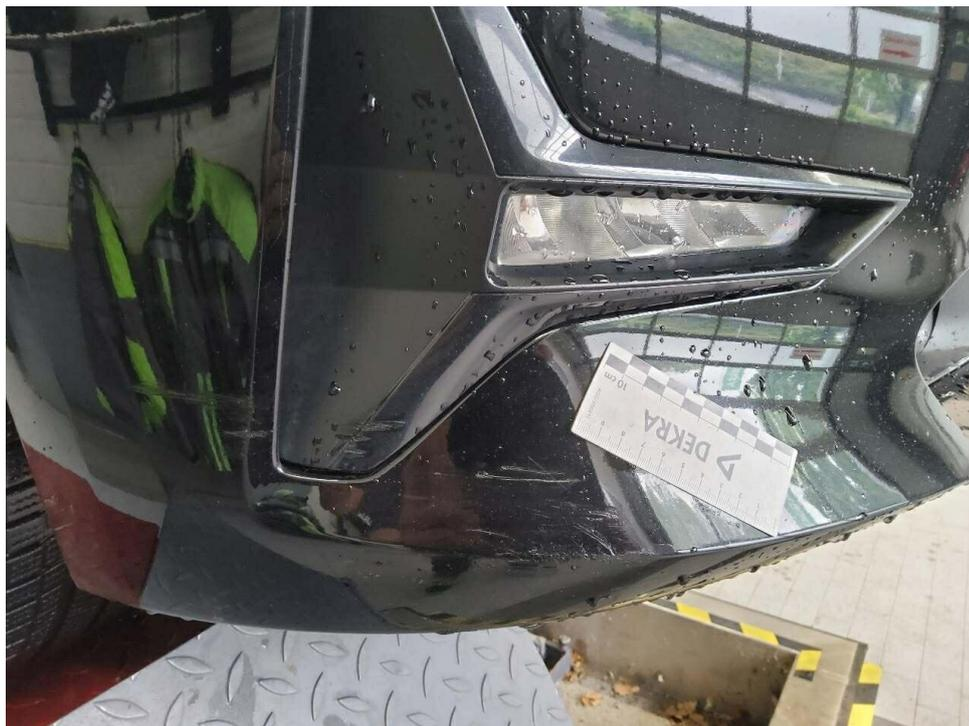
Bild 15 : Stoßfänger vorne verformt und zerkratzt, Blende Nebelscheinwerfer rechts zerkratzt
