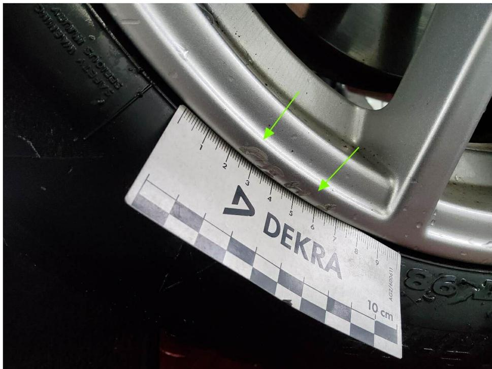
Bild 43 : Winterfelge vorne rechts zerkratzt
