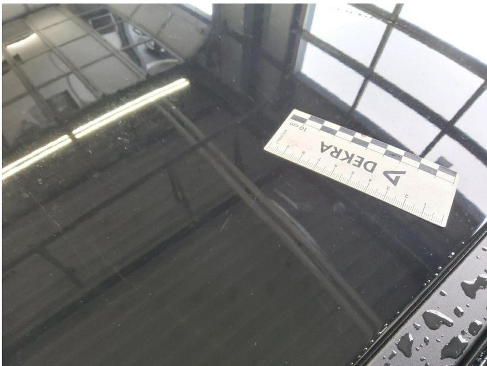
Bild 50 : Dach Lackierung, zerkratzt, polieren
