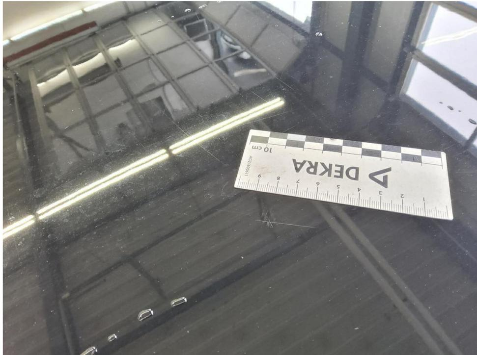
Bild 51 : Dach Lackierung, zerkratzt, polieren
