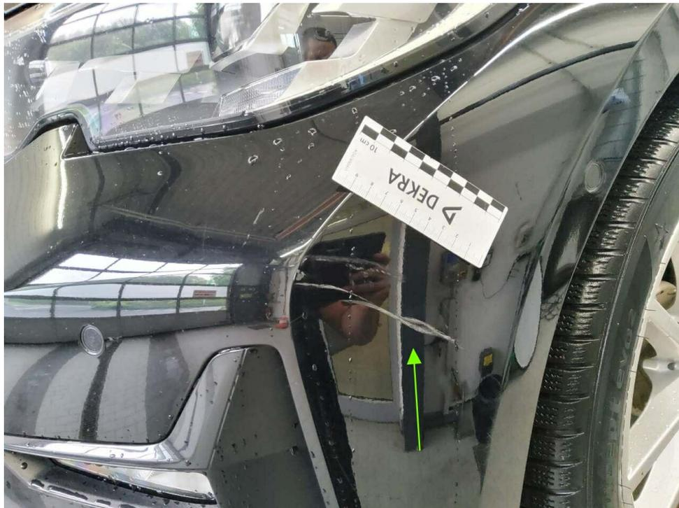
Bild 19 : Stoßfänger vorne verformt und zerkratzt, Blende Nebelscheinwerfer rechts zerkratzt
