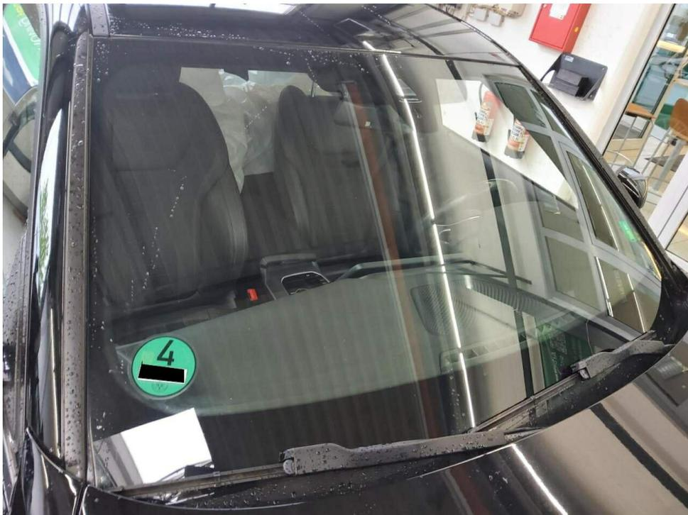
Bild 48 : Frontscheibe, Steinschlag, Gebrauchsspur
