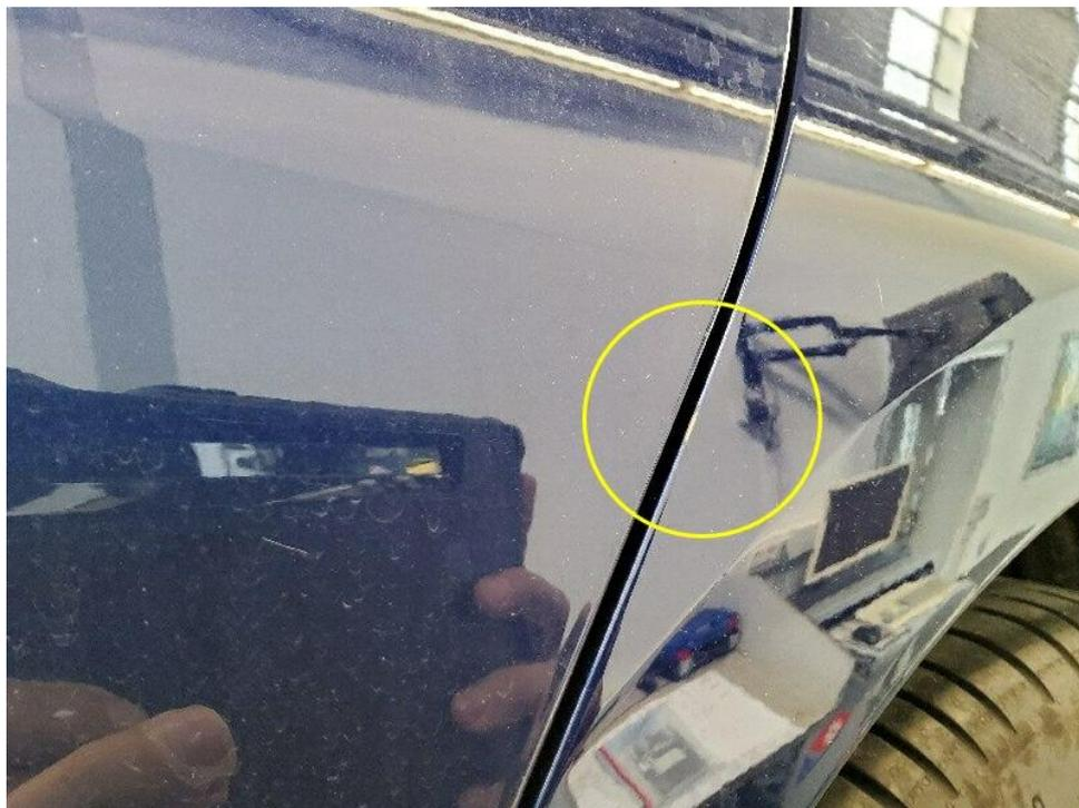
Bild 26 : Tür hinten links Türkante, Lackabplatzer, smart repair
