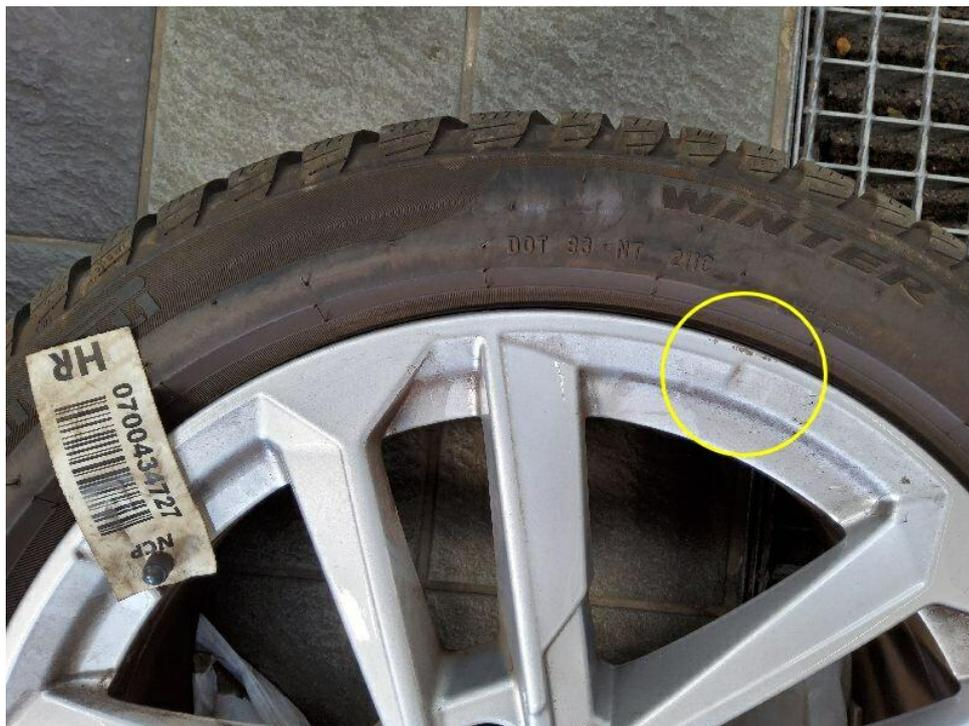
Bild 36 : Felge Winterrad Hinterachse rechts Kratzer
