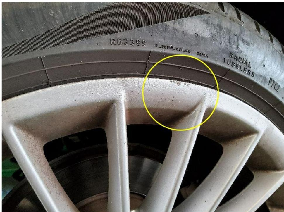
Bild 33 : Felge hinten rechts Lackierung, zerkratzt, smart repair
