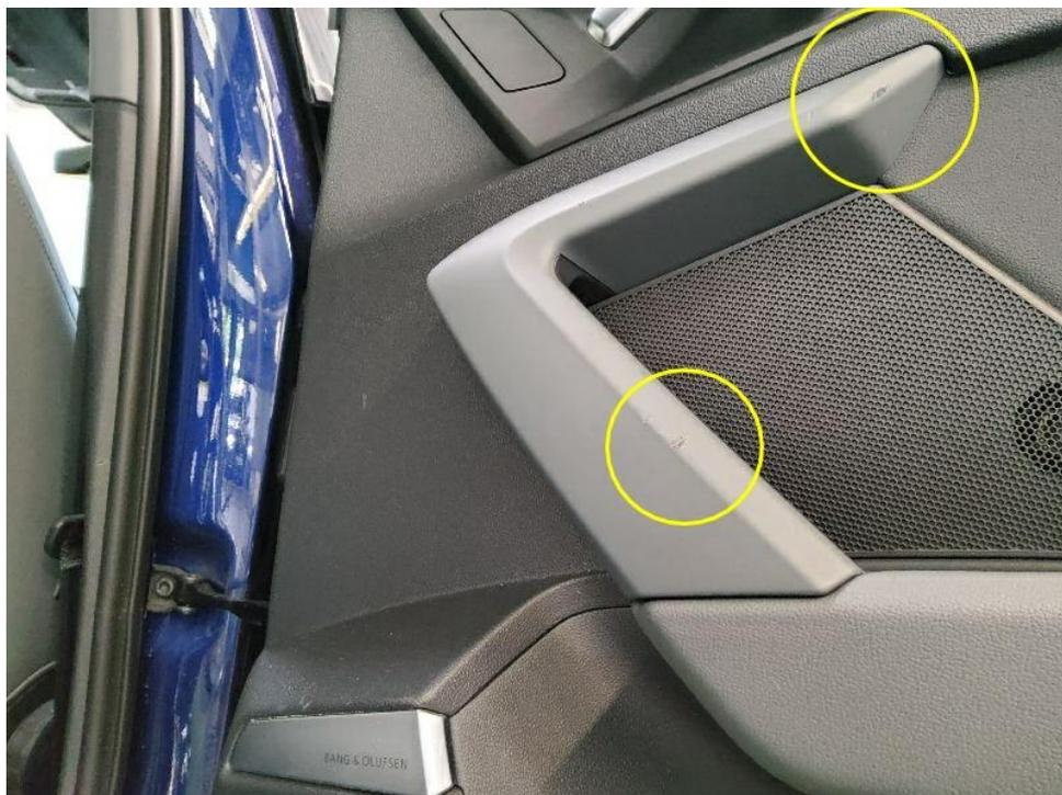
Bild 31 : Verkleidung Tür hinten Griff rechts, zerkratzt, erneuern
