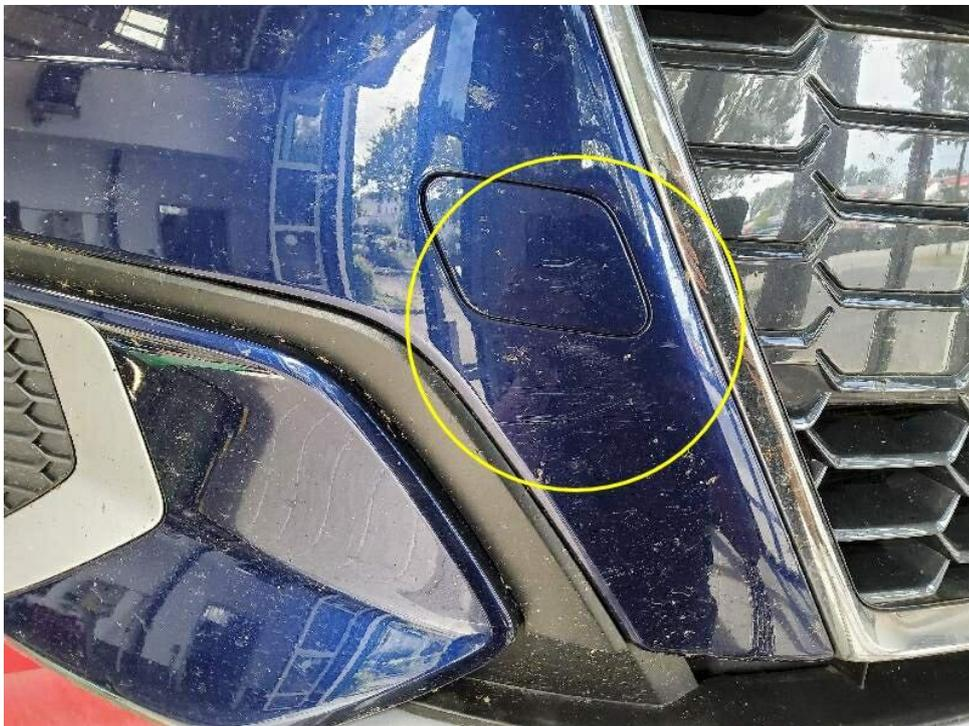
Bild 21 : Stoßfänger vorne Lackierung, zerkratzt, lackieren mit Lackaufbau
