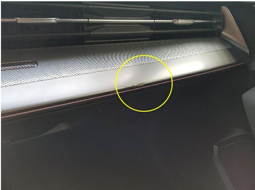
Bild 16 : Zierleiste Handschufach rechts beschädigt
