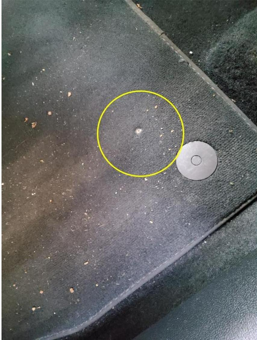
Bild 17 : Bodenbelag vorne Fußmatte links, gerissen, erneuern
