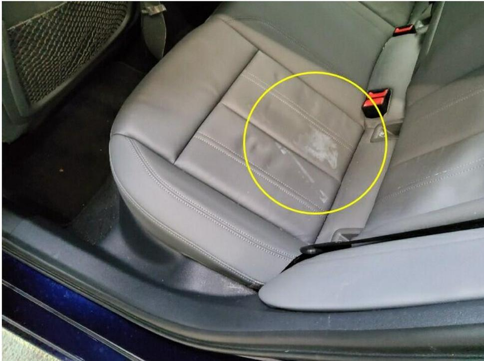
Bild 15 : Sitz 1.Reihe links Sitzbezug, verschmutzt, reinigen
