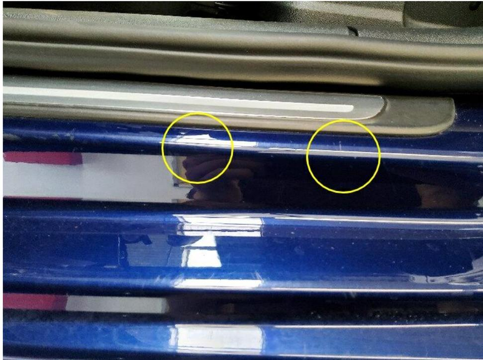
Bild 28 : Tür vorne links Einstieg Lackierung, zerkratzt, Gebrauchsspur
