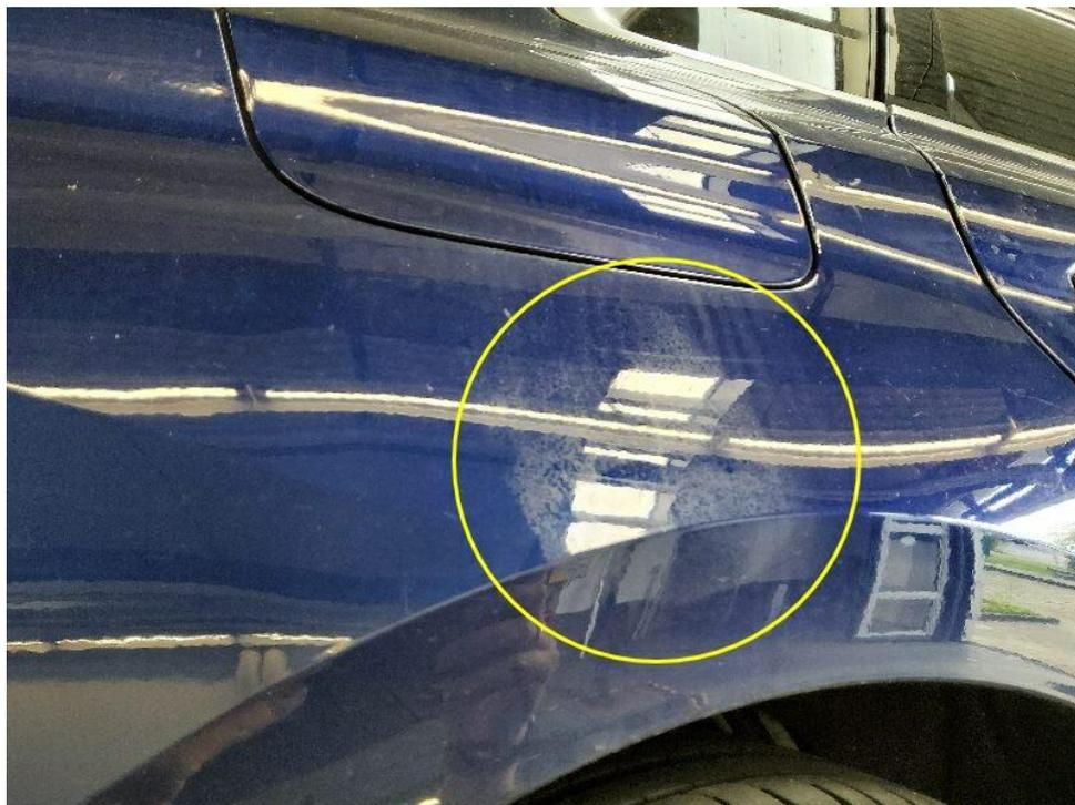
Bild 30 : Seitenteil hinten rechts Lackierung, Umweltschaden, polieren
