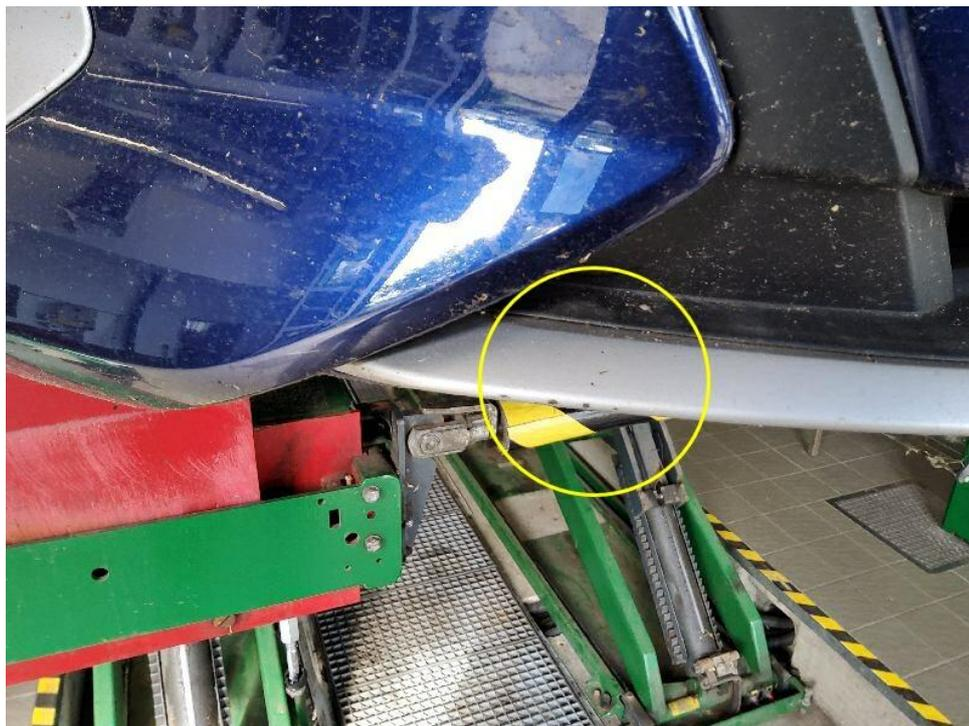
Bild 24 : Spoilerlippe vorne zerkratzt
