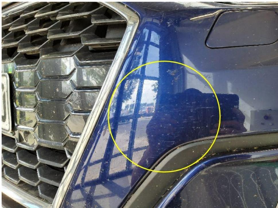
Bild 22 : Stoßfänger vorne Lackierung, zerkratzt, lackieren mit Lackaufbau
