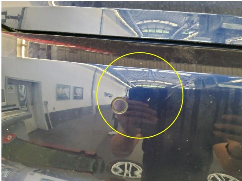
Bild 29 : Stoßfänger hinten Lackierung, zerkratzt, smart repair
