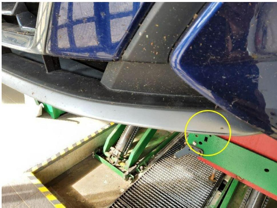
Bild 25 : Spoilerlippe vorne zerkratzt
