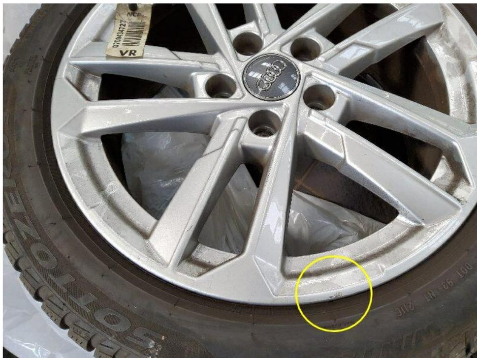
Bild 37 : Felge Winterrad Vorderachse rechts Kratzer
