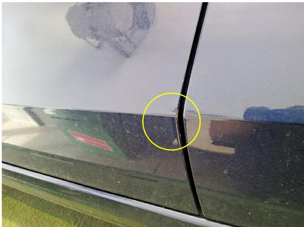
Bild 27 : Tür vorne links Türkante, Lackabplatzer, smart repair
