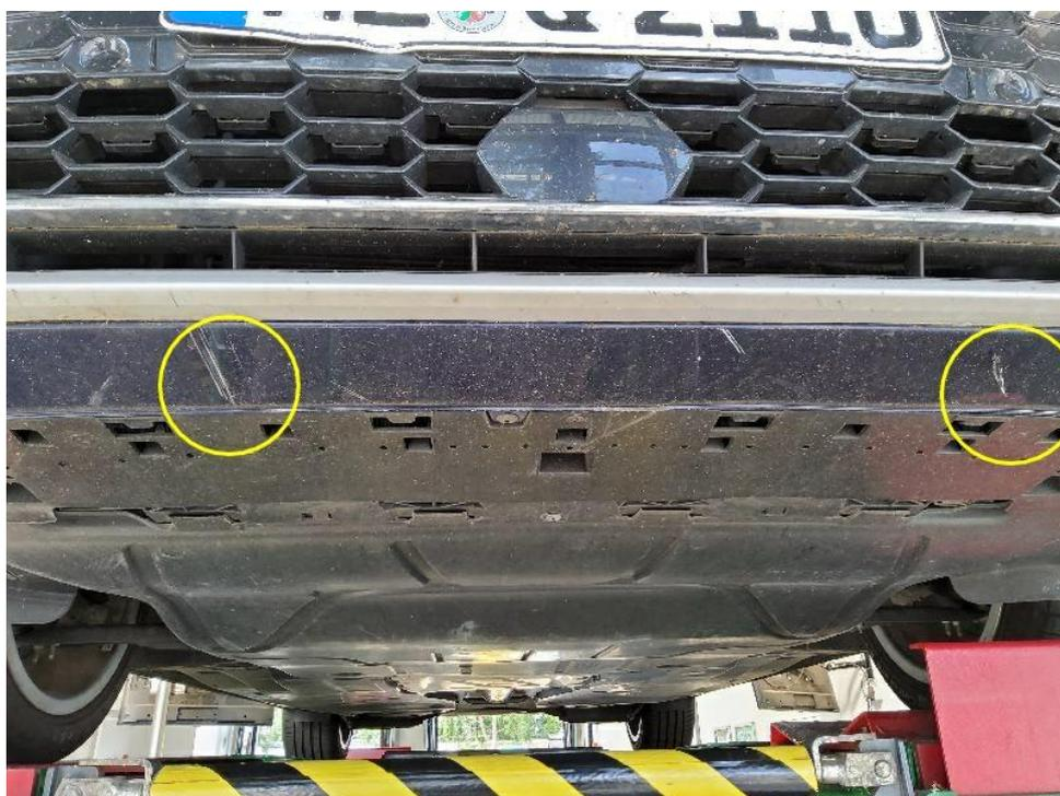
Bild 23 : Stoßfänger vorne Lackierung, zerkratzt, lackieren mit Lackaufbau
