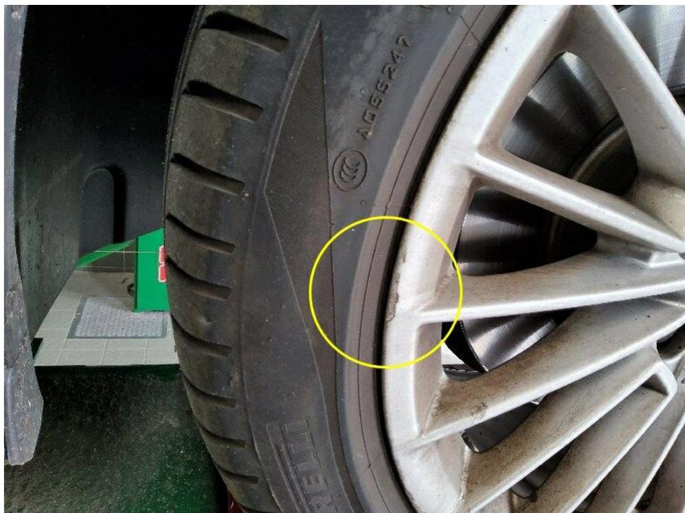
Bild 35 : Felge vorne rechts Lackierung, zerkratzt, smart repair
