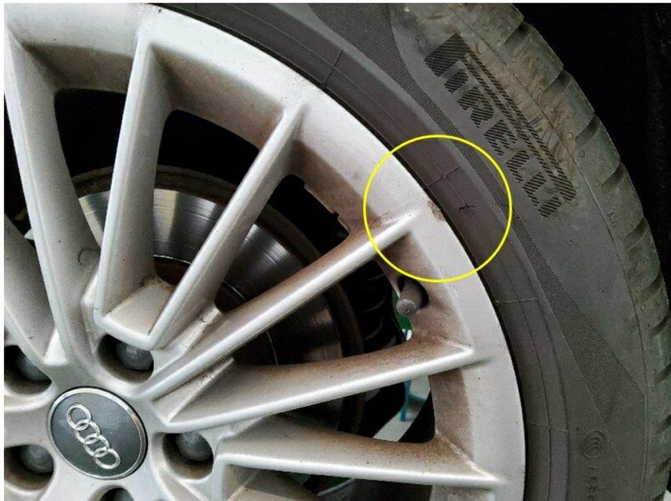
Bild 32 : Felge hinten links Lackierung, zerkratzt, smart repair
