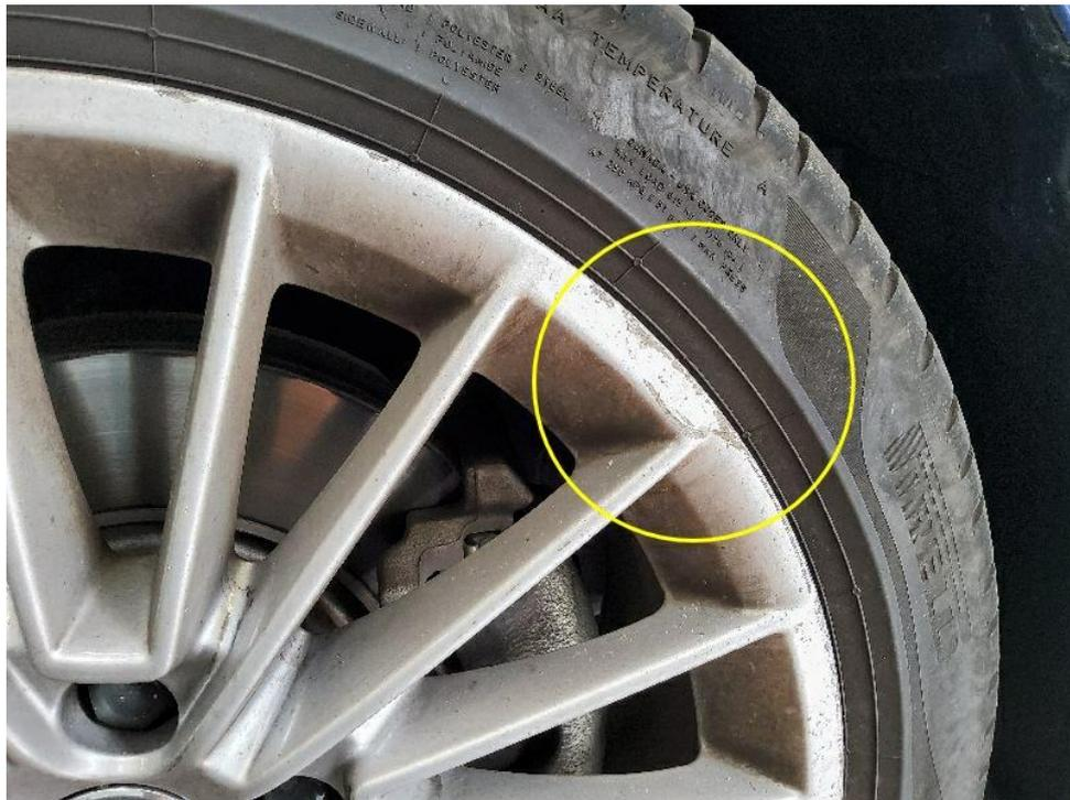
Bild 34 : Felge vorne rechts Lackierung, zerkratzt, smart repair
