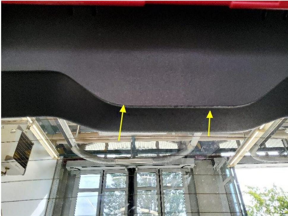
Bild 20 : Verkleidung Heckklappe, zerkratzt, Gebrauchsspur
