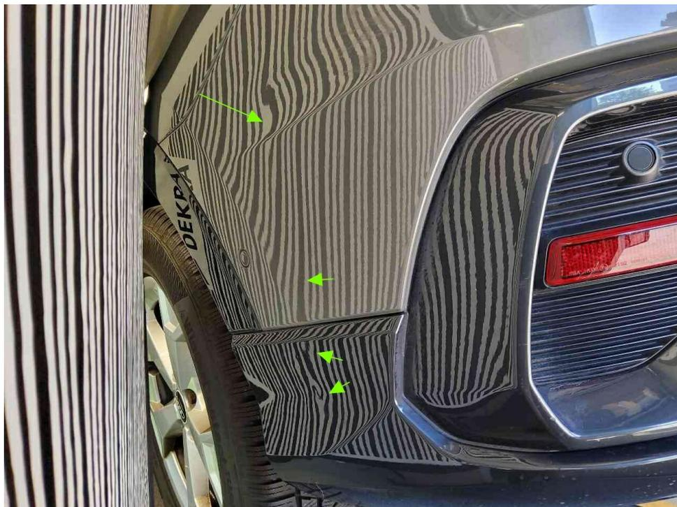
Bild 19 : Stoßfängerabdeckung hinten links inkl. Unterteil, deformiert
