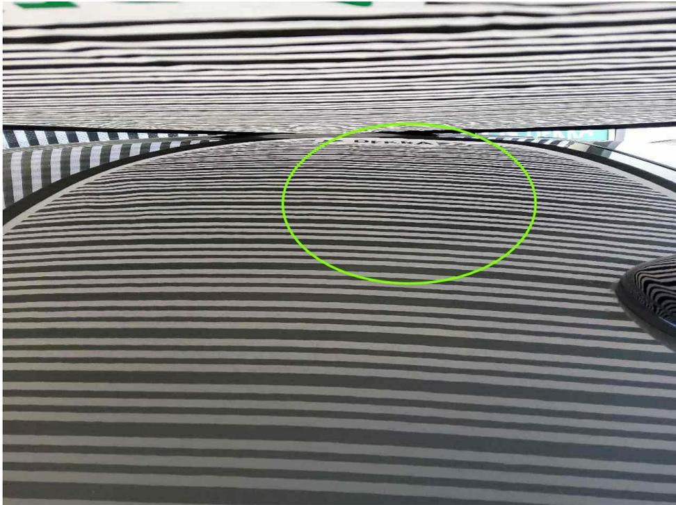
Bild 15 : Dach, mehrfach eingedellt
