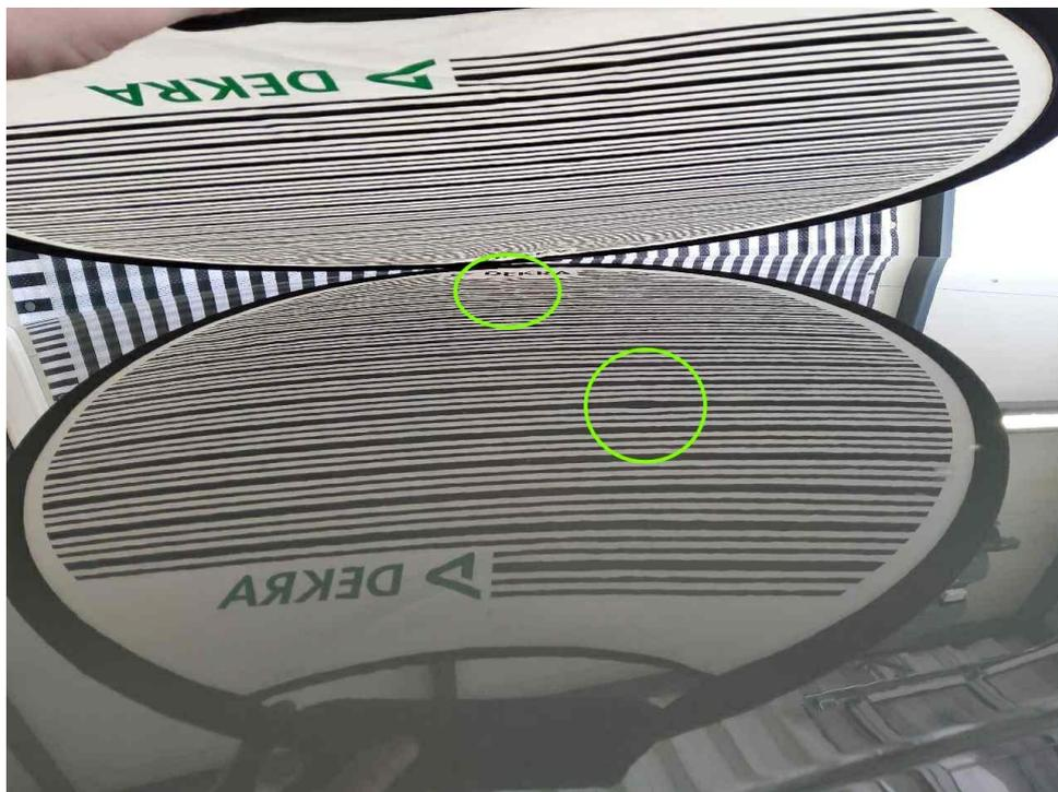
Bild 14 : Dach, mehrfach eingedellt
