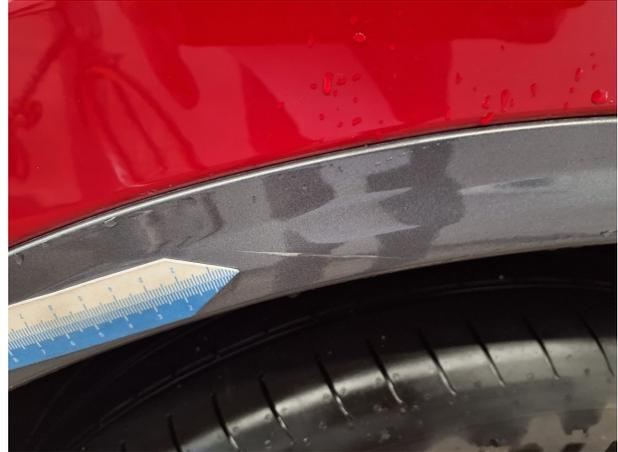
**Beschädigung #1:** Seitenwand rechts: Radlauf - Kratzer - Smart Repair
