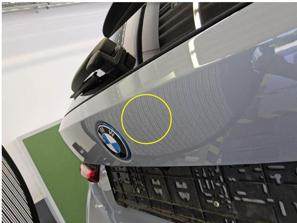
Bild 18 : Heckklappe eingedellt
