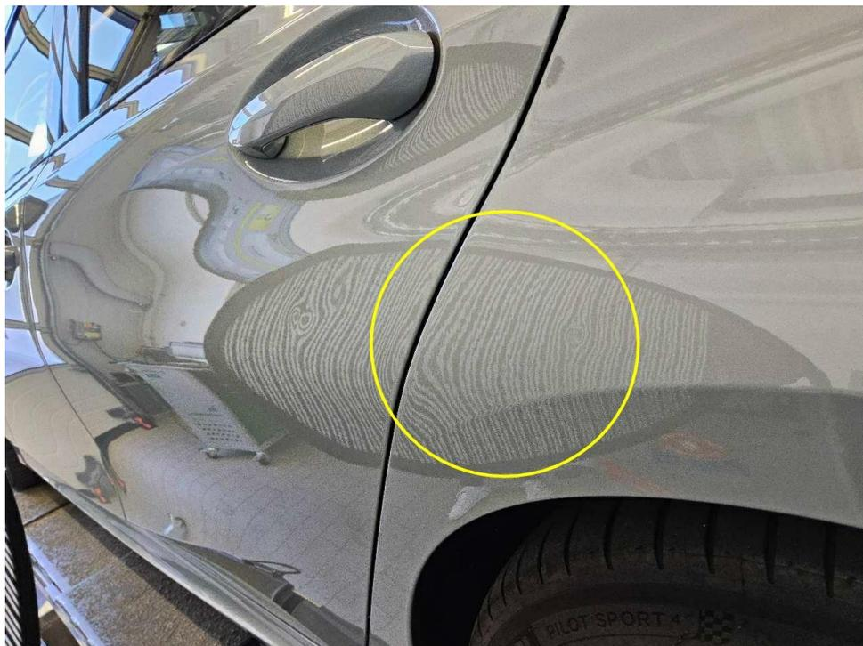
Bild 17 : Seitenwand links mehrfach eingedellt
