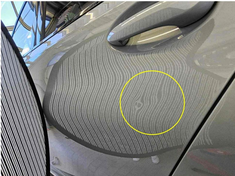
Bild 16 : Tür hinten links mehrfach eingedellt
