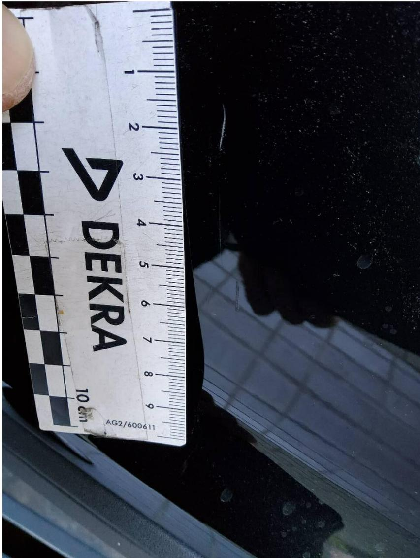
Bild 20 : Stoßfänger hinten Lackierung, zerkratzt, lackieren mit Lackaufbau
