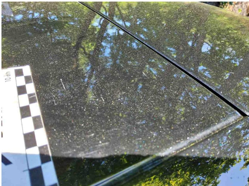
Bild 25 : Dach Lackierung, zerkratzt, lackieren mit Lackaufbau
