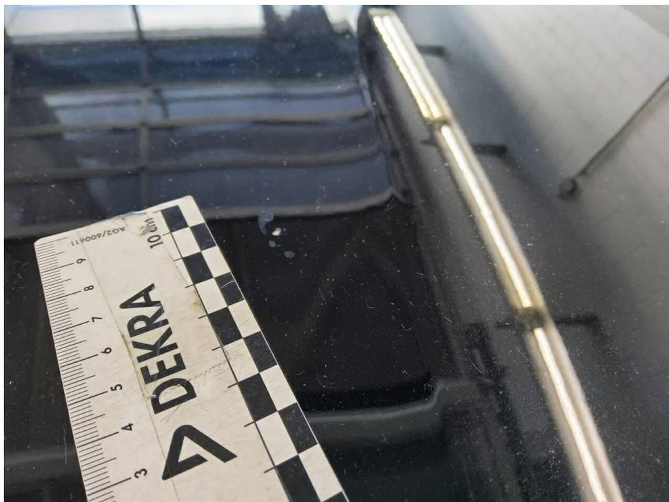
Bild 22 : Motorhaube Lackierung, fleckig, lackieren mit Lackaufbau
