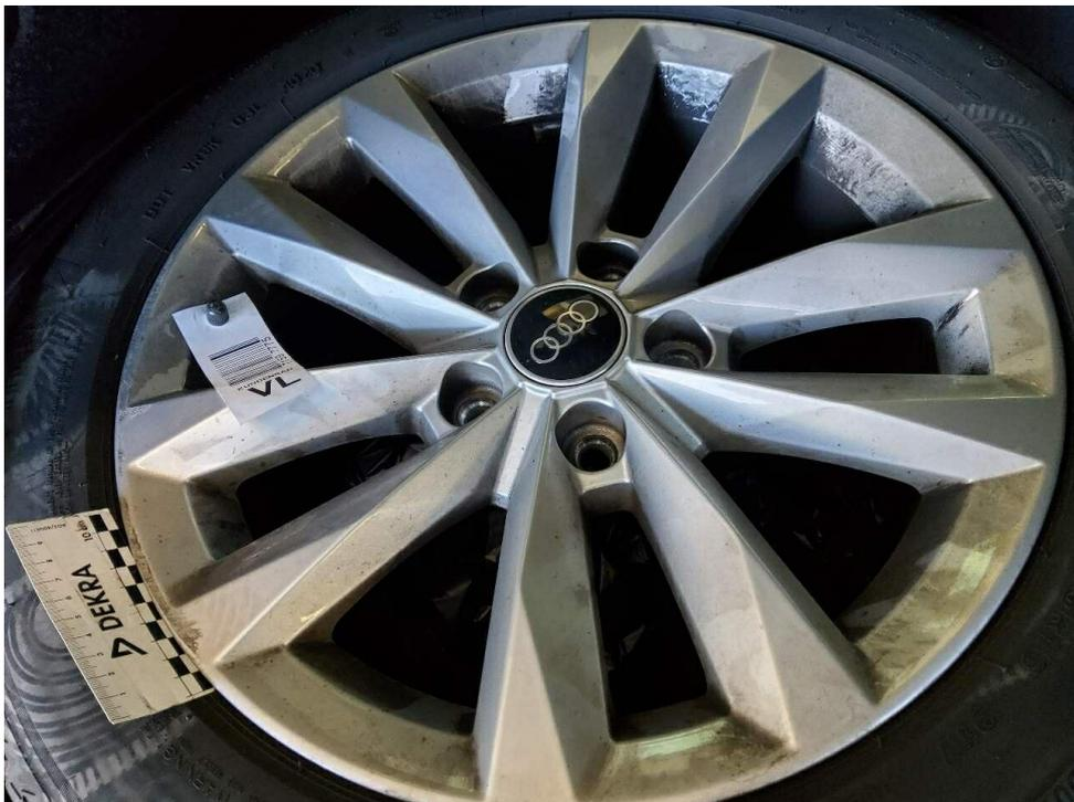
Bild 14 : Felge1 Sommerradstanz verschrammt
