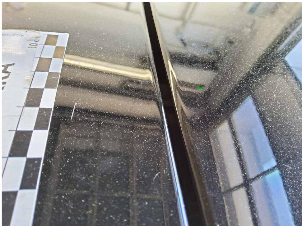
Bild 24 : Dach Lackierung, zerkratzt, lackieren mit Lackaufbau
