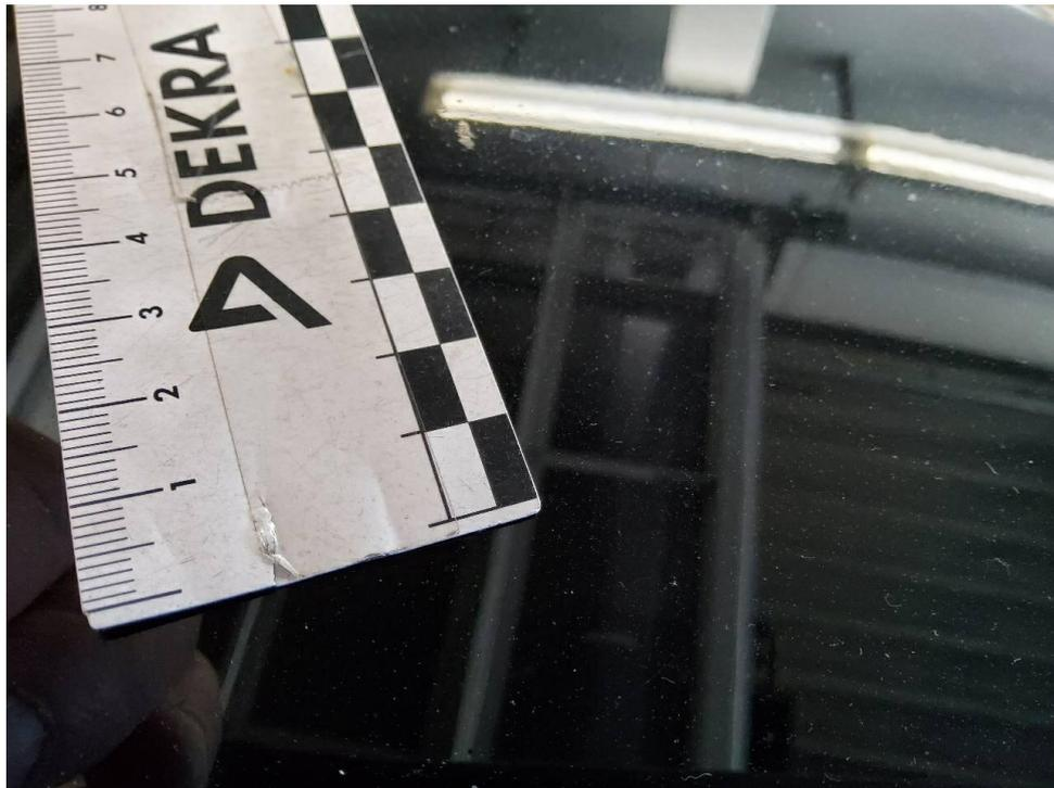
Bild 23 : Motorhaube Lackierung, fleckig, lackieren mit Lackaufbau
