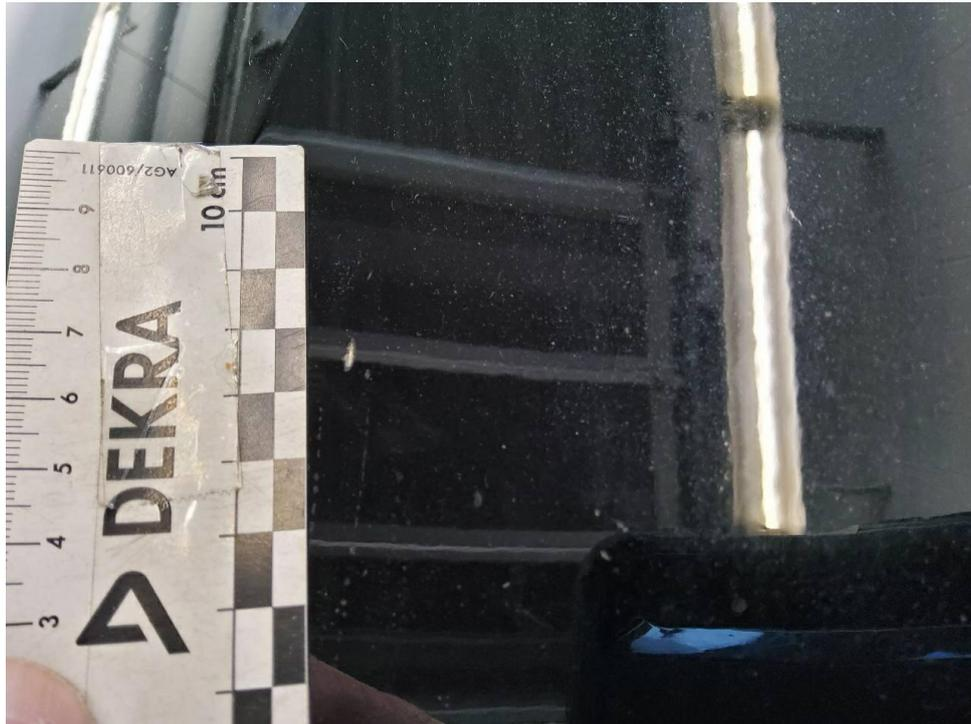
Bild 21 : Motorhaube Lackierung, Steinschlag, lackieren mit Lackaufbau
