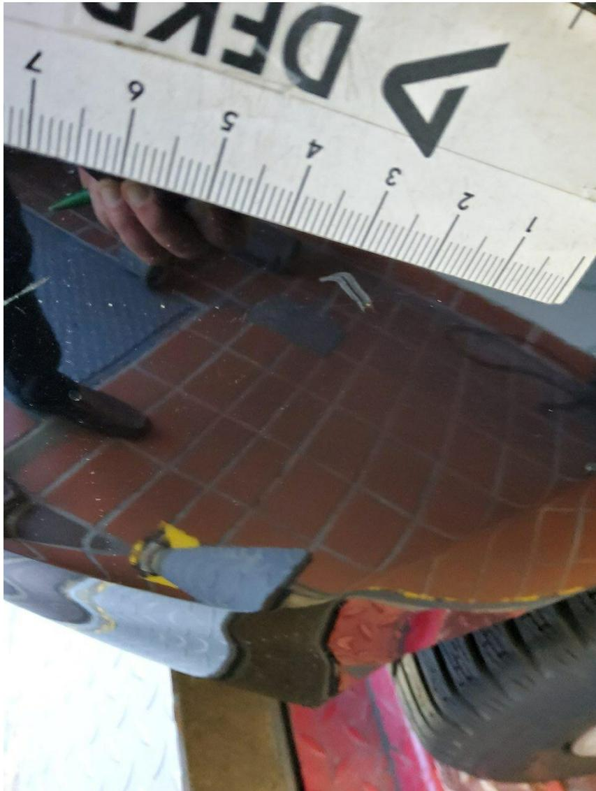
Bild 19 : Stoßfänger hinten Lackierung, zerkratzt, lackieren mit Lackaufbau
