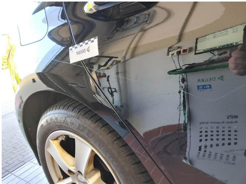
Bild 17 : Tür hinten rechts Lackierung, zerkratzt, lackieren mit Lackaufbau
