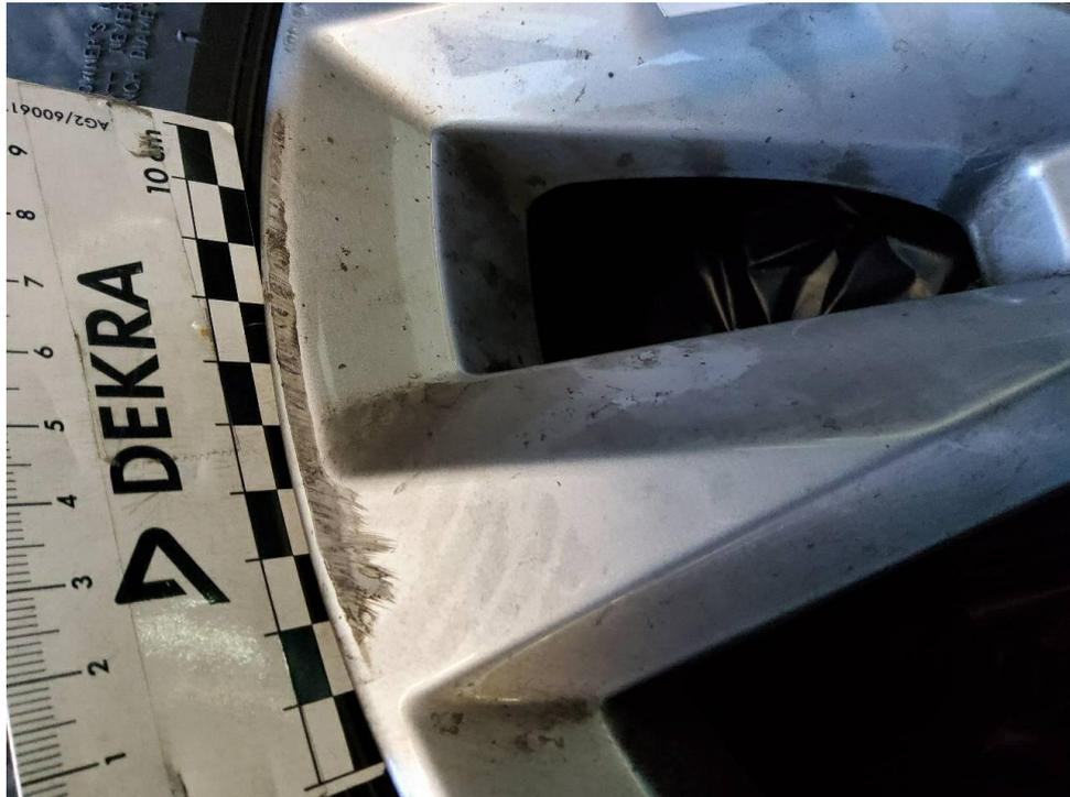
Bild 15 : Felge1 Sommeradstanz verschrammt
