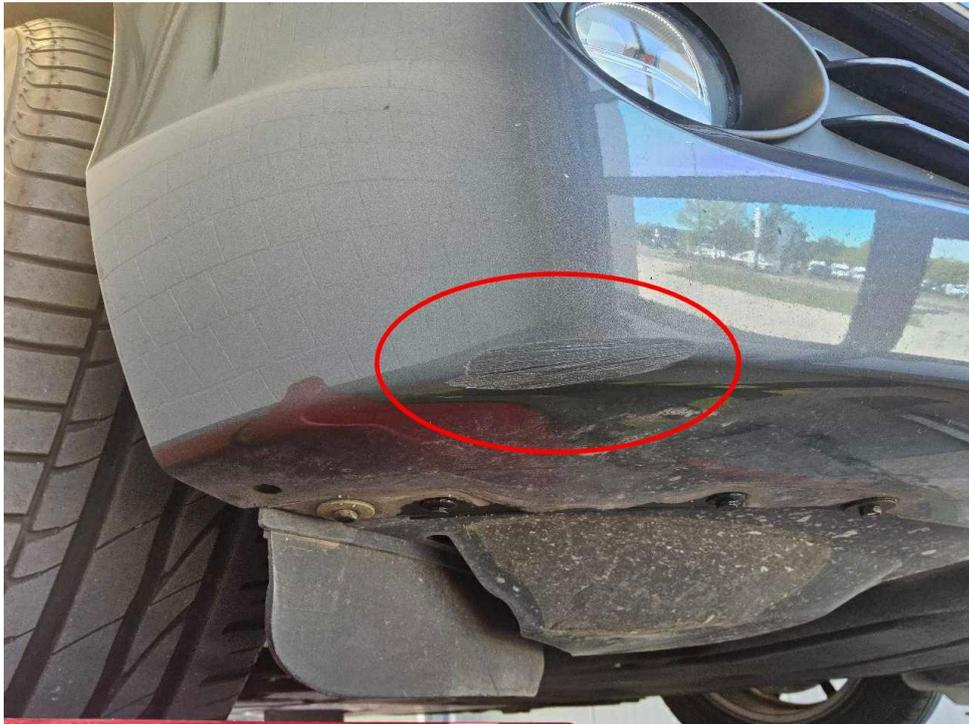
Bild 15 : Frontspoiler rechts unterhalb verschrammt
