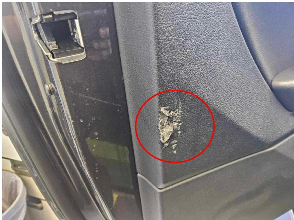
Bild 14 : Türverkleidung Fahrertür beschädigt
