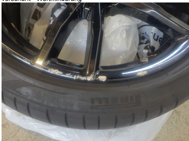
Beschädigung #4: 2.Radsatz: 2 Leichtmetallfelgen - verkratzt / verschürft - Wertminderung
