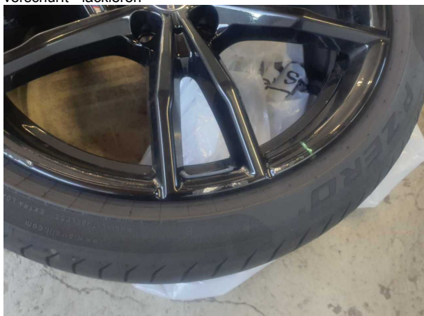
Beschädigung #4: 2.Radsatz: 2 Leichtmetallfelgen - verkratzt / verschürft - Wertminderung
