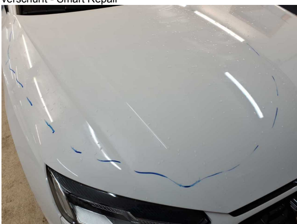
Beschädigung #8: Motorhaube: Motorhaube - Kratzer - instandsetzen und lackieren
