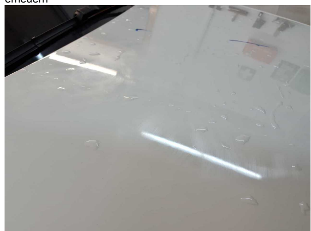
Beschädigung #8: Motorhaube: Motorhaube - Kratzer - instandsetzen und lackieren
