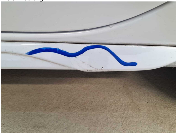
Beschädigung #6: Schweller links: Verkleidung - verkratzt / verschürft - Smart Repair
