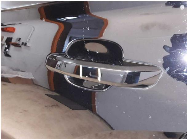
**Beschädigung #3:** Tür hinten links: Griff außen - verkratzt / verschürft - Smart Repair
