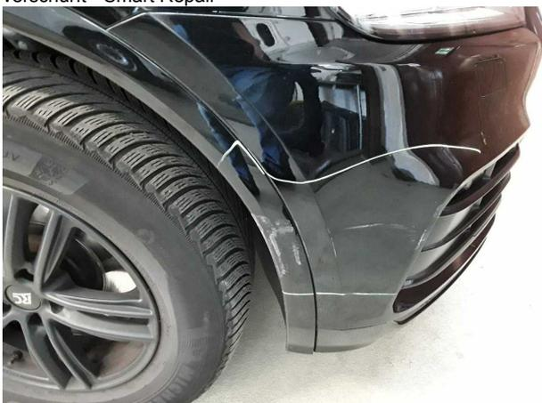
**Beschädigung #6:** Kotflügel rechts: Radlauf - verkratzt / verschürft - erneuern
