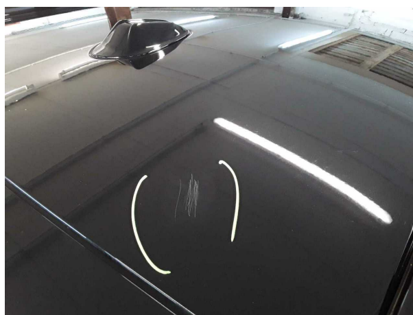
Domage #5: Toit: Toit - Eraflé - Réparer et repeindre
