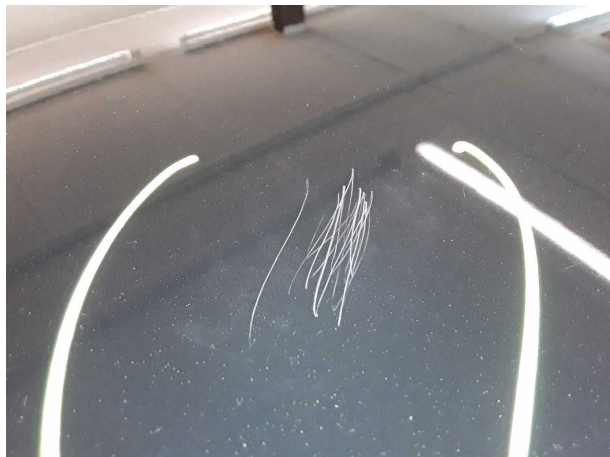
Domage #5: Toit: Toit - Eraflé - Réparer et repeindre
