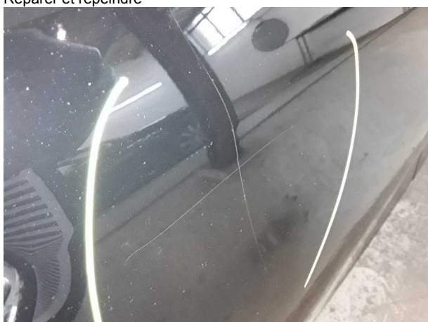
Domage #4: Porte ArD: Porte - Eraflé - Réparer et repeindre
