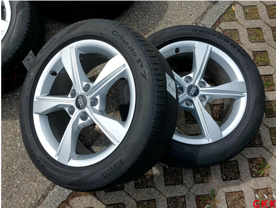
Bild 21. Reifen, 2 x beiliegend, Untermaß, ersetzen
