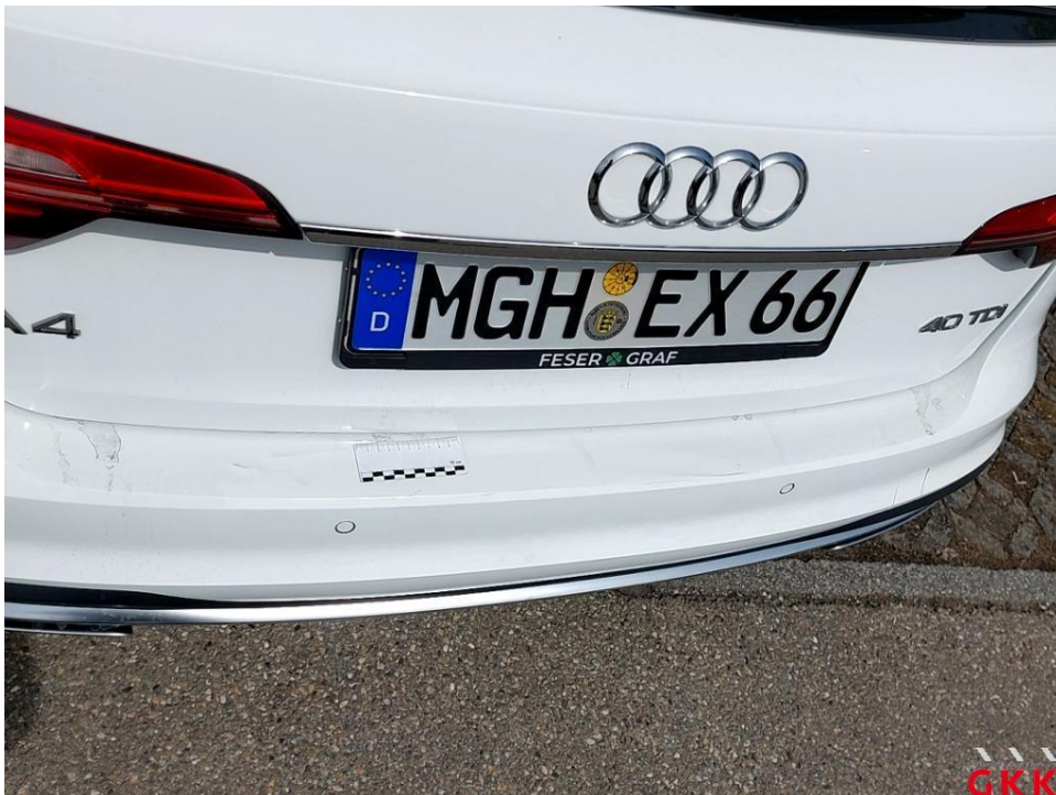
Bild 12. Stoßfänger hinten, Verkleidung -lackiert-, verkratzt, Smartrepair
