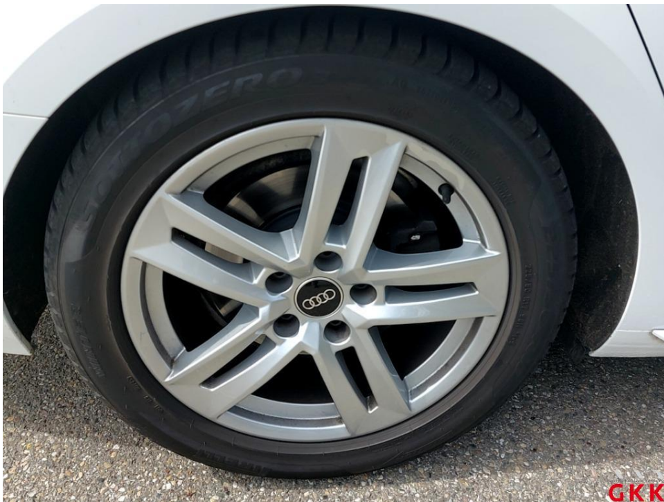
Bild 24. Reifen, hinten links und rechts, Untermaß, ersetzen
