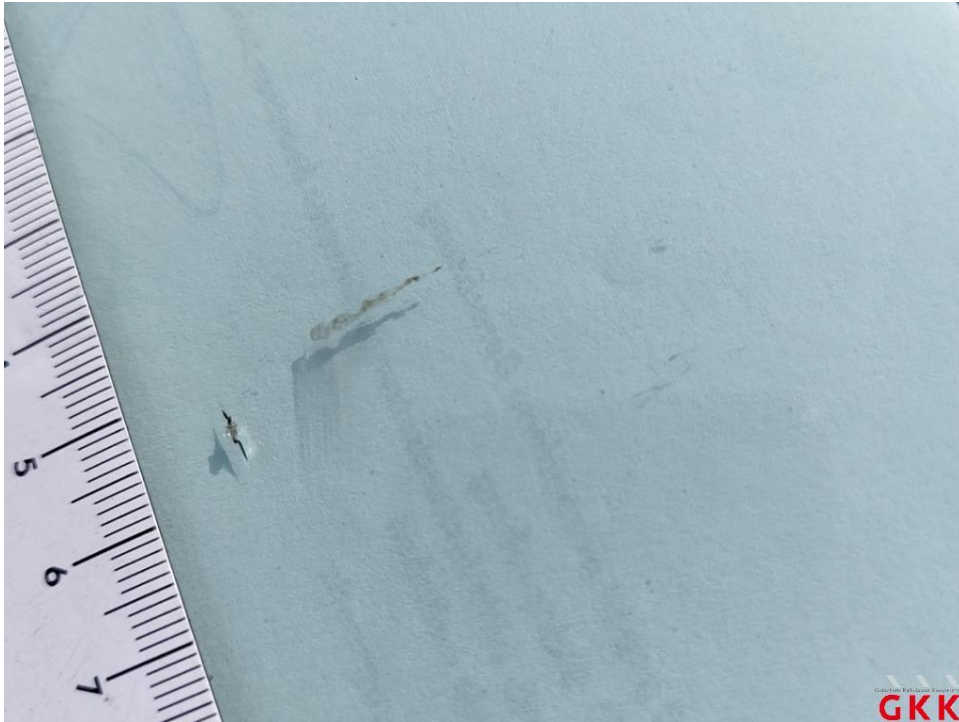
Bild 17. Frontscheibe, mit Regensensor und Frontkamera, Steinschlag im Sichtfeld, ersetzen
