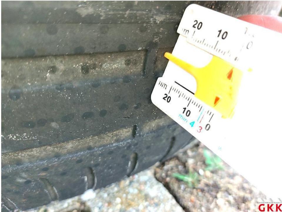
Bild 23. Reifen, 2 x beiliegend, Untermaß, ersetzen
