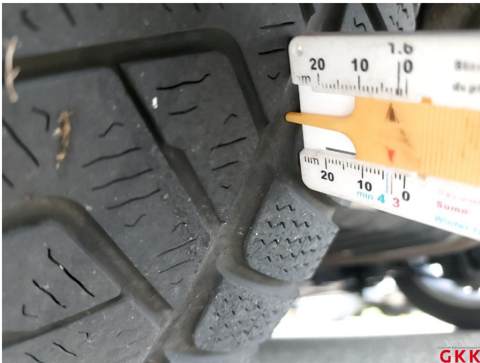
Bild 26. Reifen, hinten links und rechts, Untermaß, ersetzen
