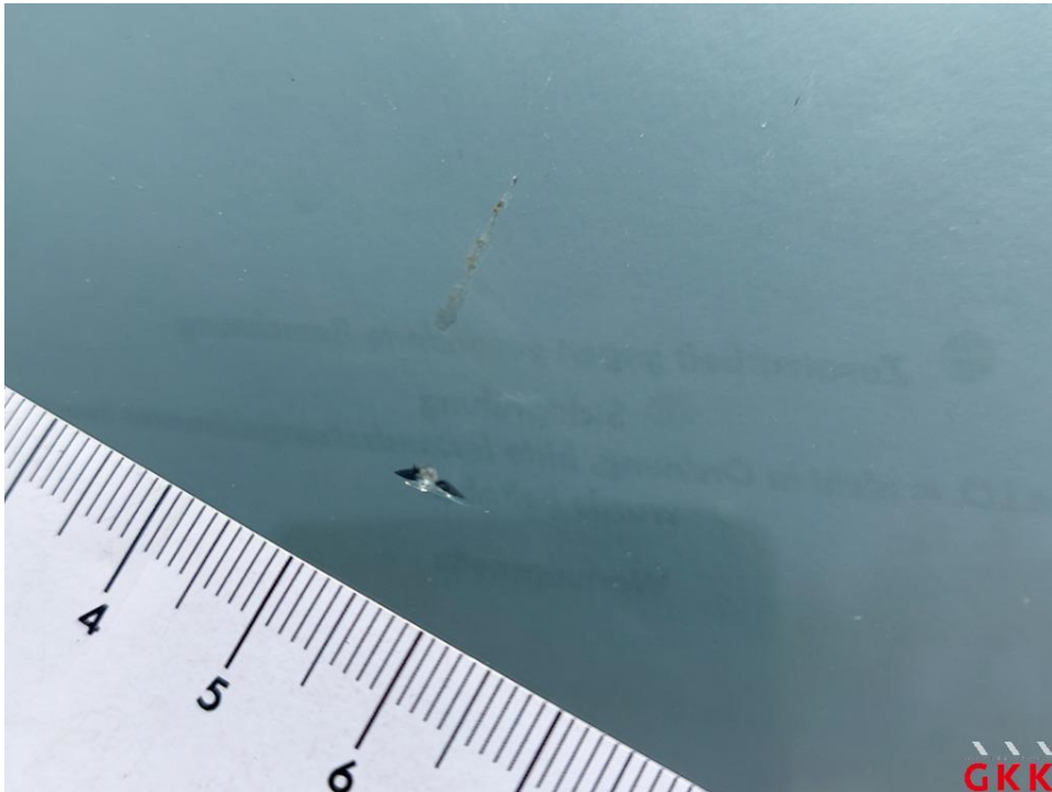
Bild 16. Frontscheibe, mit Regensensor und Frontkamera, Steinschlag im Sichtfeld, ersetzen
