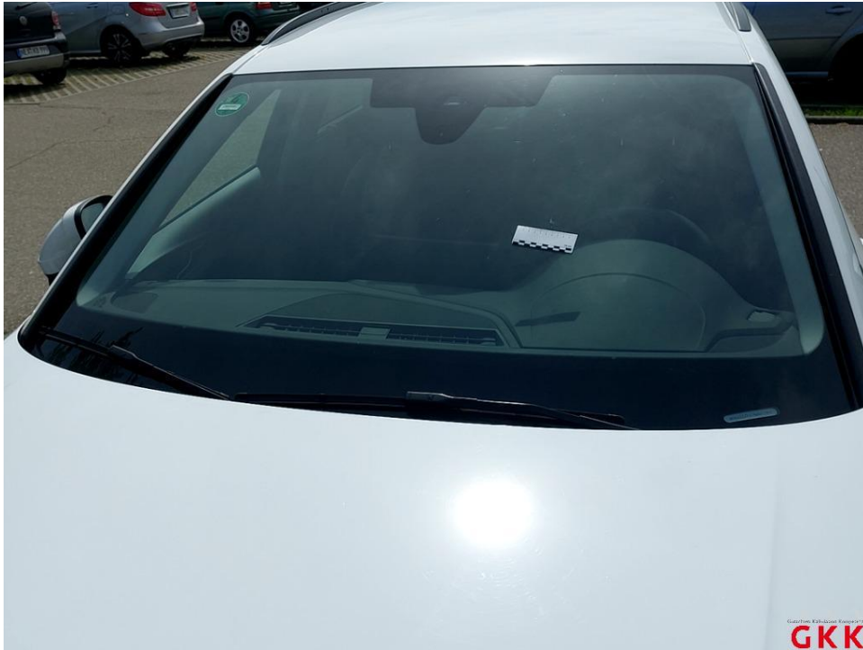
Bild 15. Frontscheibe, mit Regensensor und Frontkamera, Steinschlag im Sichtfeld, ersetzen
