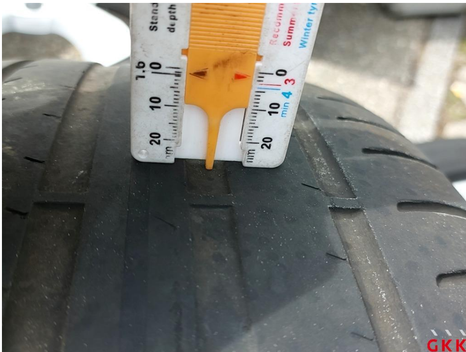
Bild 22. Reifen, 2 x beiliegend, Untermaß, ersetzen
