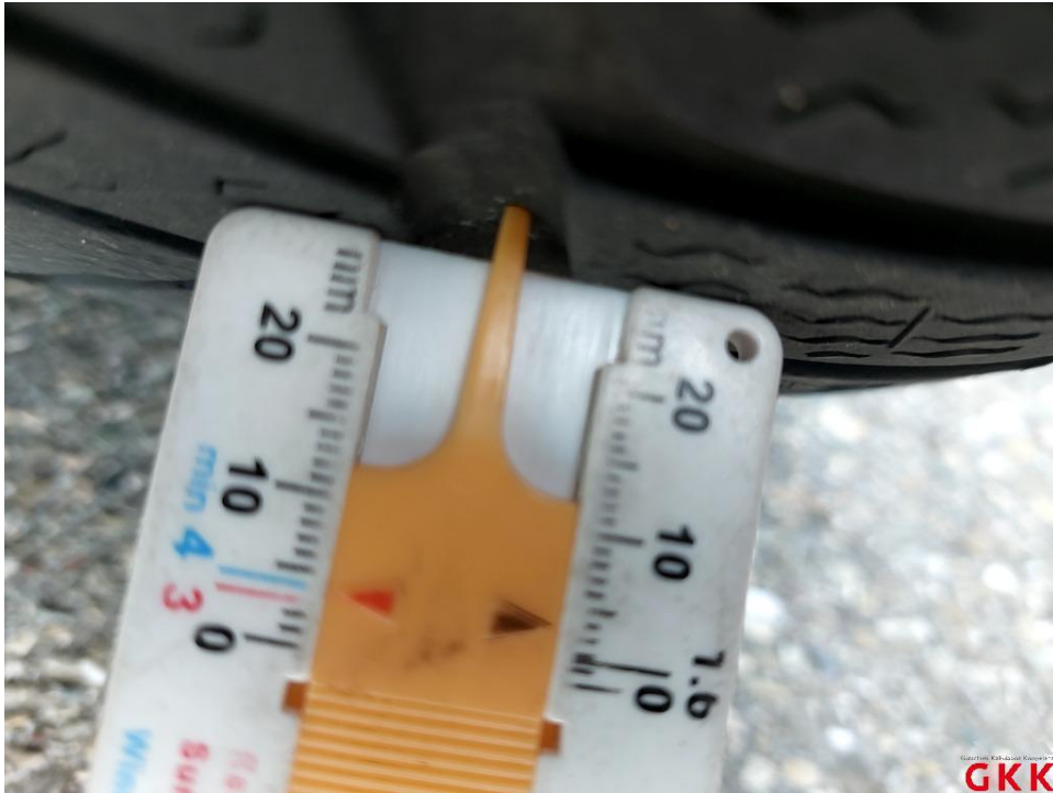
Bild 25. Reifen, hinten links und rechts, Untermaß, ersetzen
