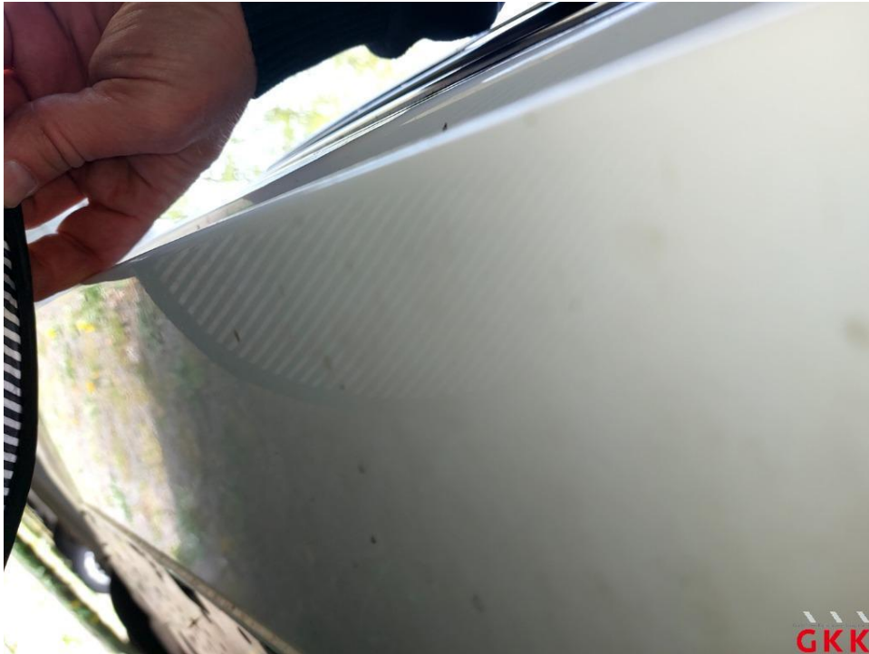
Bild 19. Stoßfänger vorne, Verkleidung -lackiert-, Reparaturmangel, polieren
