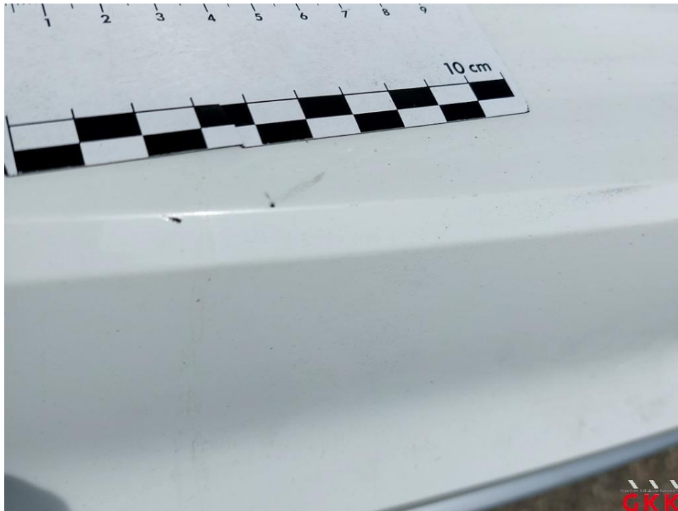
Bild 13. Stoßfänger hinten, Verkleidung -lackiert-, verkratzt, Smartrepair
