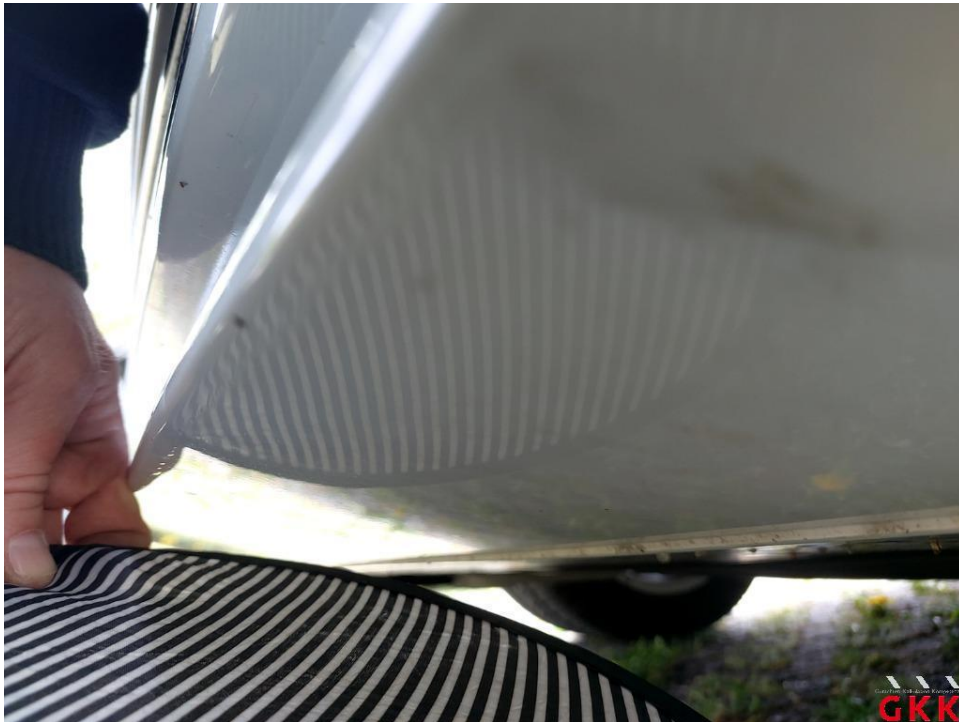
Bild 20. Stoßfänger vorne, Verkleidung -lackiert-, Reparaturmangel, polieren
