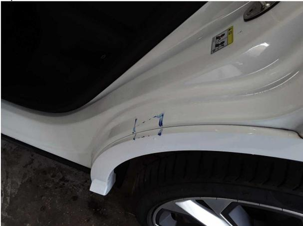
**Domage #5:** Panneau latéral arrière gauche: Elargissement du passage de roue - Eraflé - Réparation intelligente
