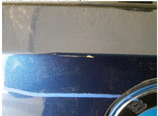
**Beschädigung #5:** Heckklappe/-tür: Heckklappe - verkratzt / verschürft - Smart Repair
