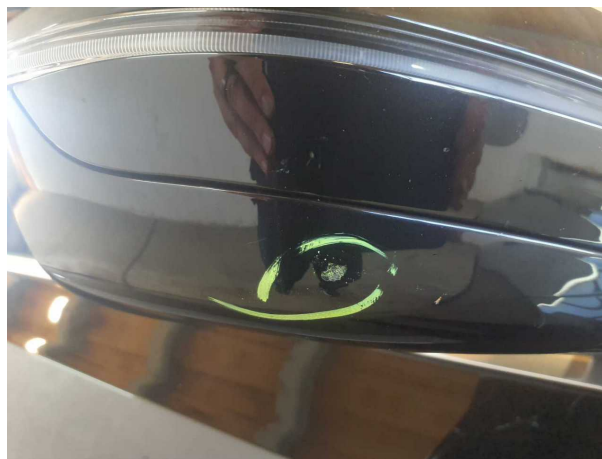
Beschädigung #1: Außenspiegel rechts: Spiegelgehäuse - verkratzt / verschürft - Smart Repair
