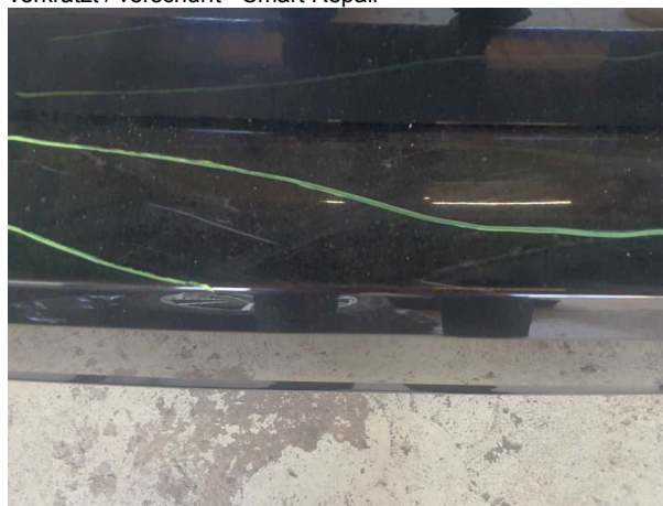
Beschädigung #2: Stossfänger hinten: Stossfänger hinten - verkratzt / verschürft - instandsetzen und lackieren
