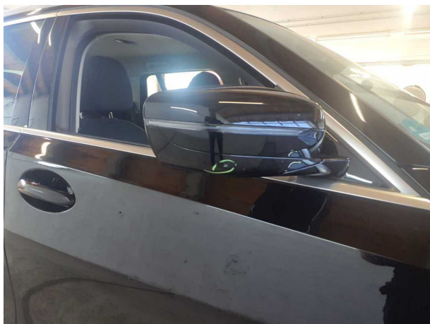
Beschädigung #1: Außenspiegel rechts: Spiegelgehäuse - verkratzt / verschürft - Smart Repair
