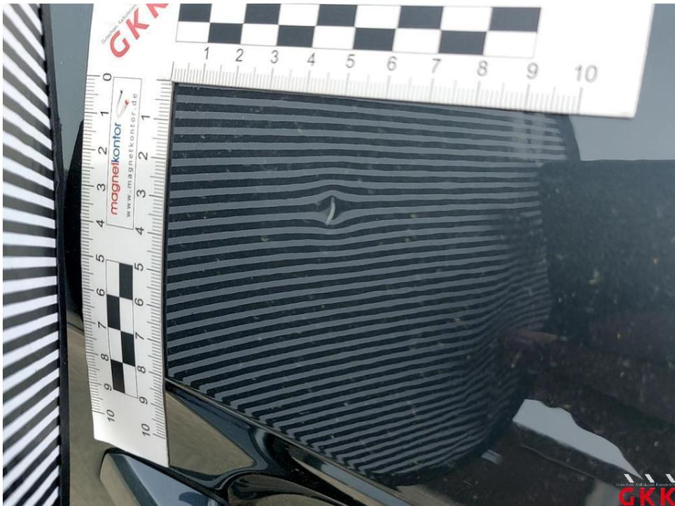
Bild 14. Tür vorne links, beschädigt, instand setzen - lackieren
