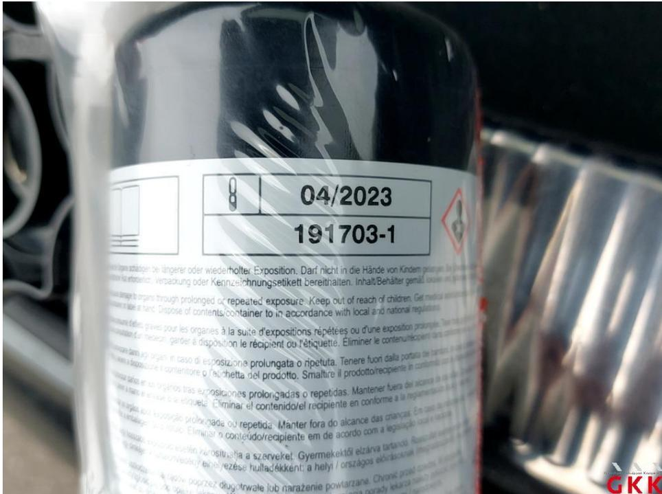
Bild 16. Reifenreparaturset, Füllflasche, MHD überschritten, ersetzen
