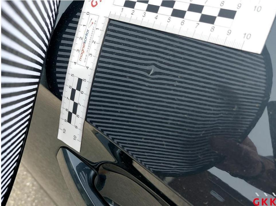
Bild 13. Tür vorne links, beschädigt, instand setzen - lackieren
