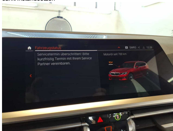
Beschädigung #3: Sonstiges: Inspektion/Wartung - fällig - durchführen
