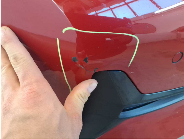
Beschädigung #4: Stossfänger vorn: Stossfänger vorn (Gebrochen) - beschädigt - erneuern
