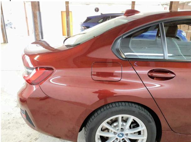
**Beschädigung #4:** Seitenwand rechts: Seitenwand - Kratzer - Smart Repair
