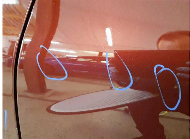
**Beschädigung #8:** Tür hinten links: Tür - Delle(n) - sanft instandsetzen
