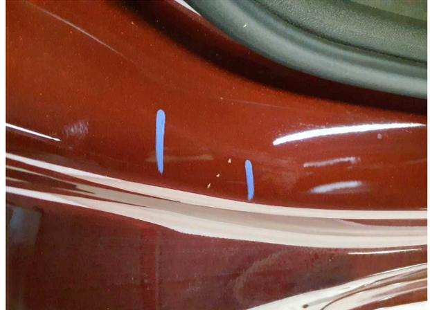
**Beschädigung #5:** Seitenwand rechts: Einstieg - Kratzer - Smart Repair
