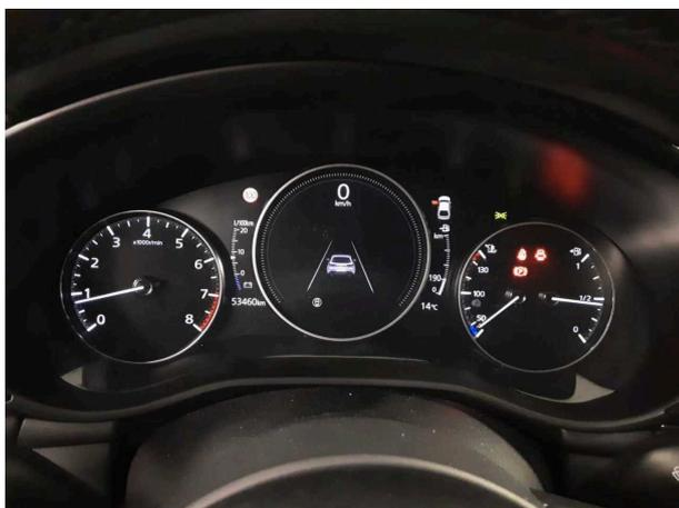
**Abbildung 9: Kombiinstrument**
