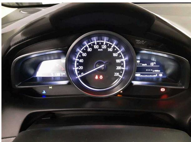
Abbildung 9: Kombiinstrument
