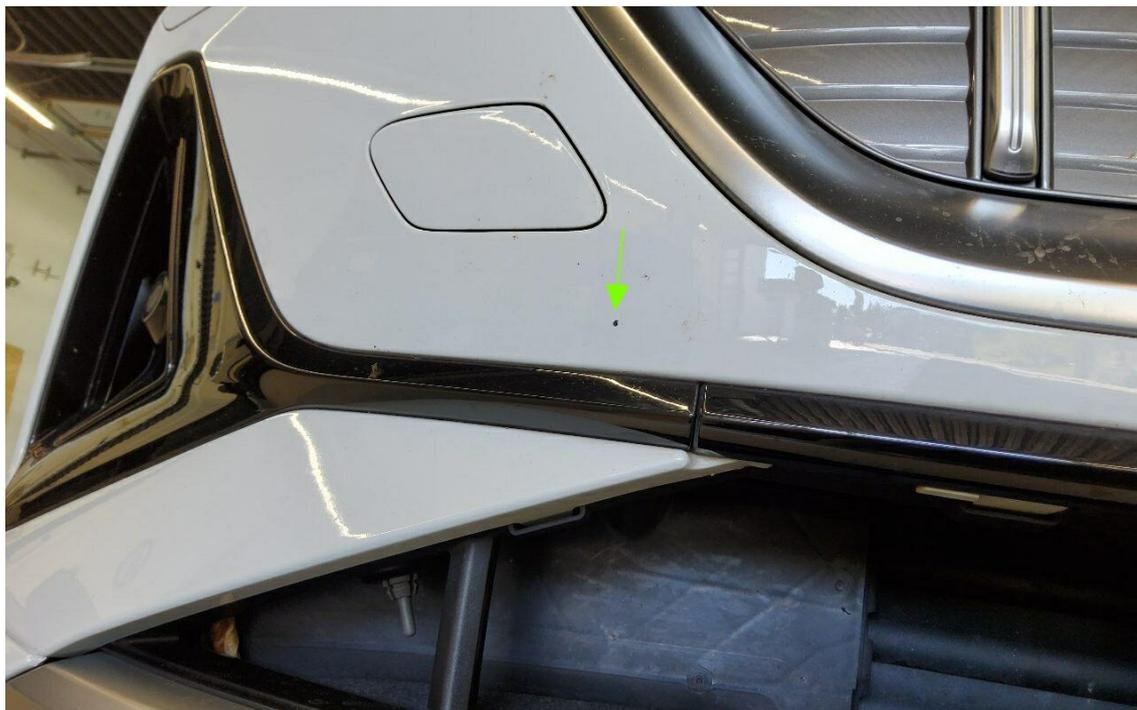
Bild 17 : Stoßfänger vorne Lackierung Steinschlag
