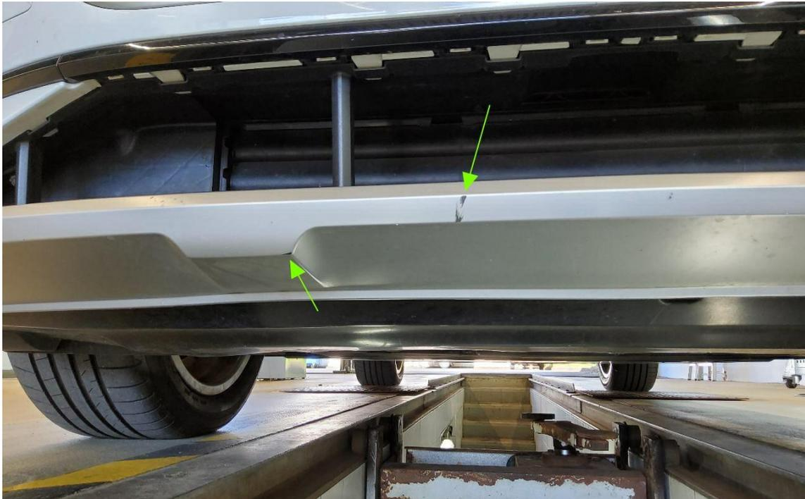
Bild 15 : Stoßfänger vorne Spoiler zerkratzt
