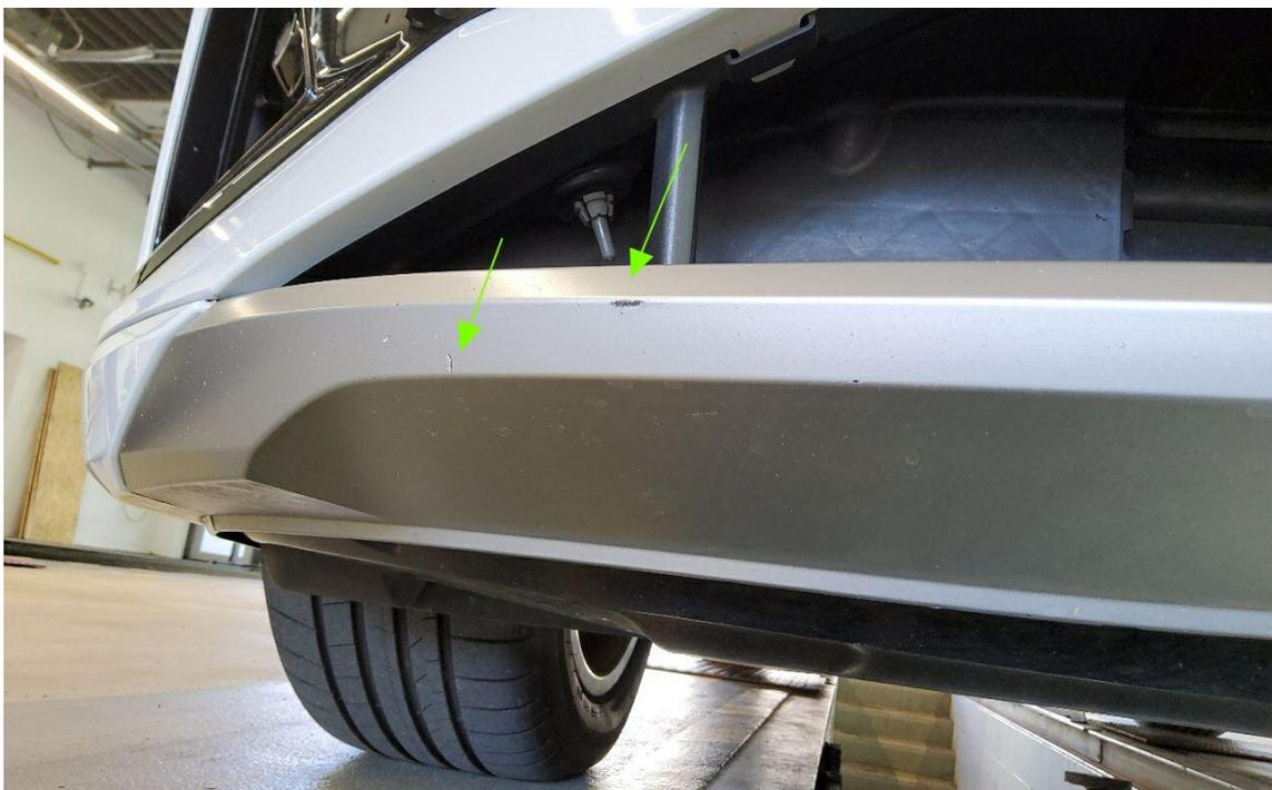
Bild 16 : Stoßfänger vorne Spoiler zerkratzt
