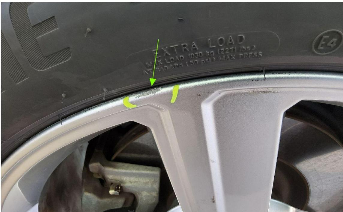
Bild 14 : Leichtmetallfelge hinten links zerkratzt
