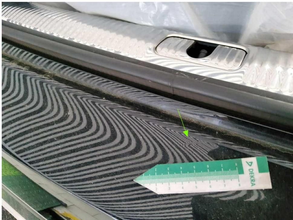
Bild 23 : zeigt den Schadenbereich Stoßfänger hinten mehrfach verschrammt
