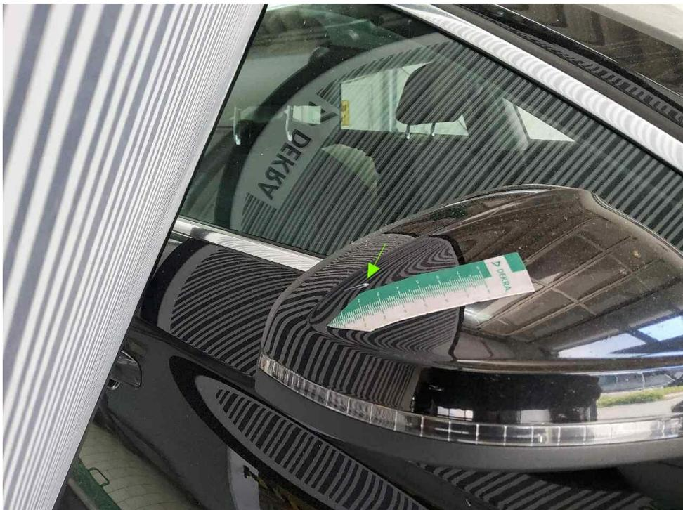
Bild 18 : zeigt den Schadenbereich Aussenspiegel rechte Seite verschrammt
