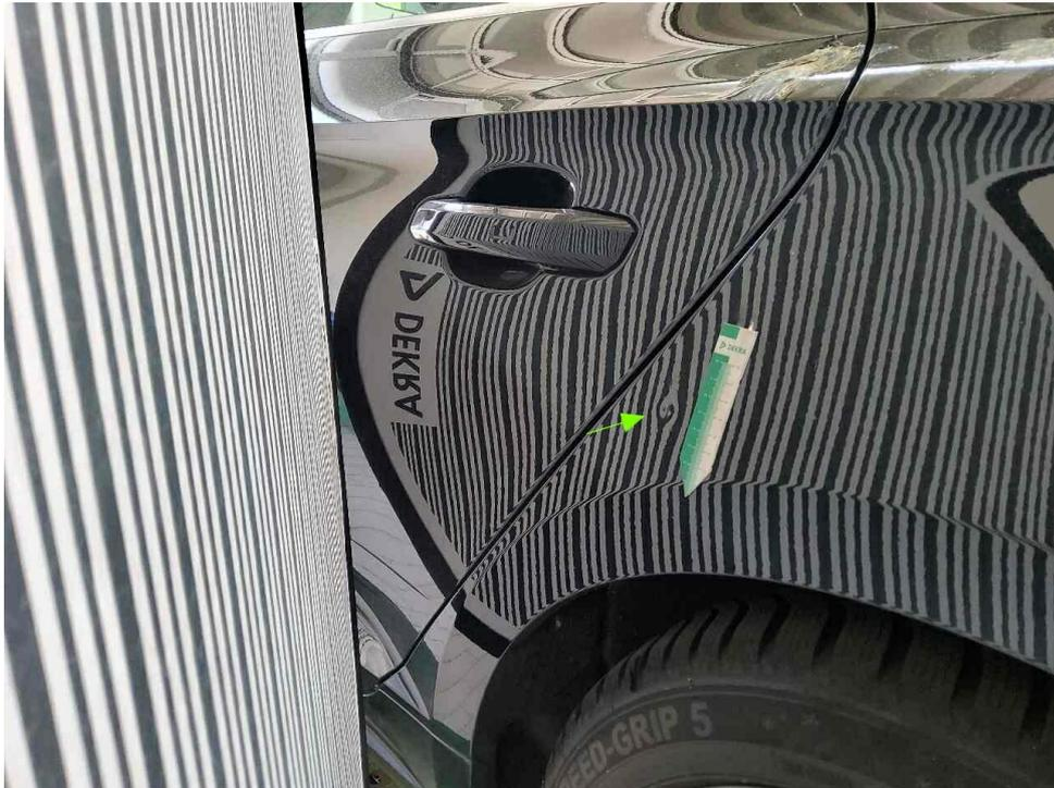
Bild 19 : zeigt den Schadenbereich Seitenwand hinten links Delle
