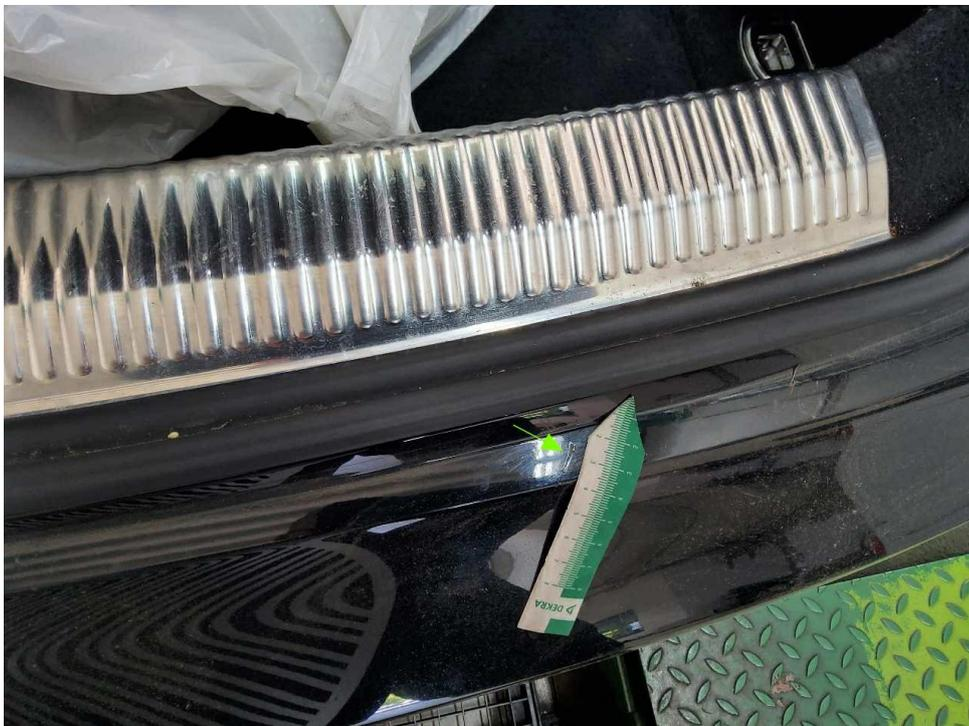
Bild 20 : zeigt den Schadenbereich Stoßfänger hinten mehrfach verschrammt
