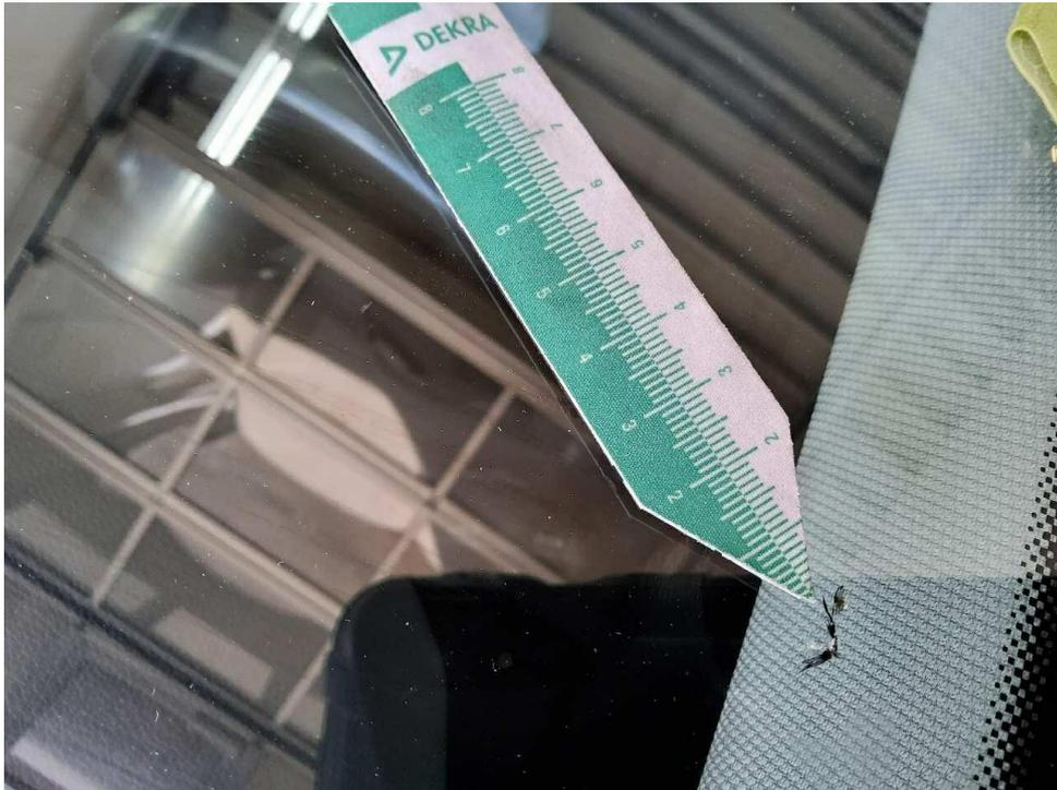
Bild 15 : zeigt den Schadenbereich Windschutzscheibe gerissen
