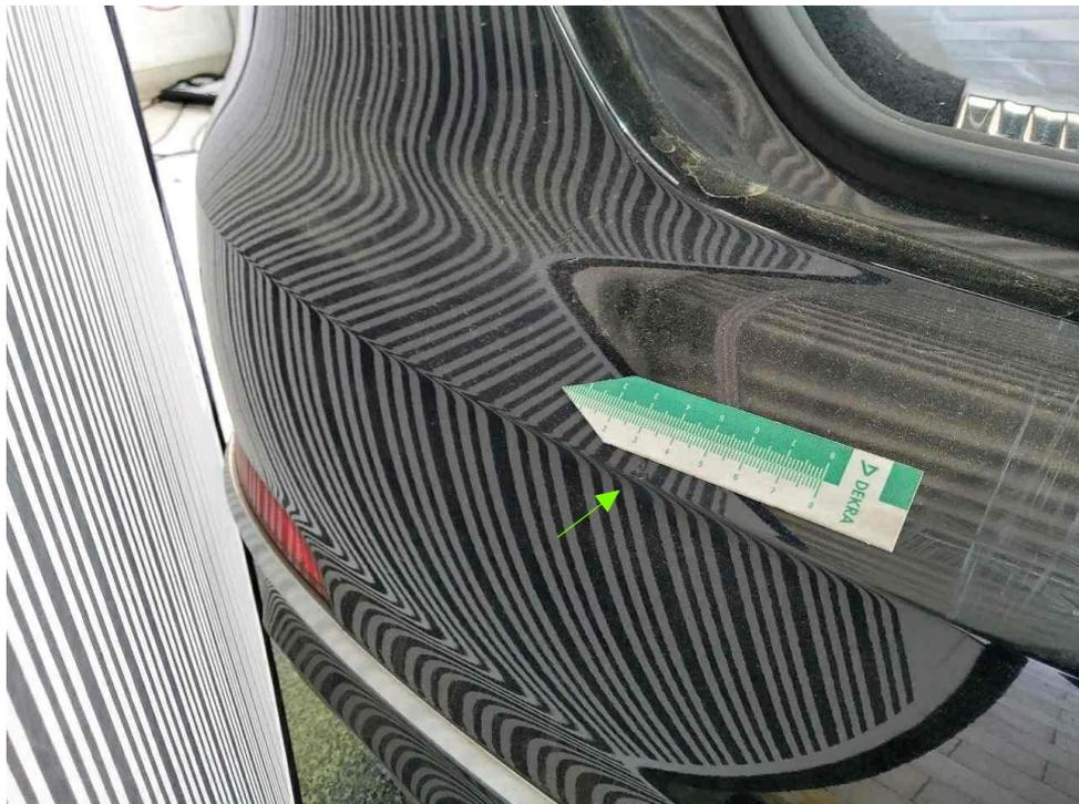
Bild 22 : zeigt den Schadenbereich Stoßfänger hinten mehrfach verschrammt
