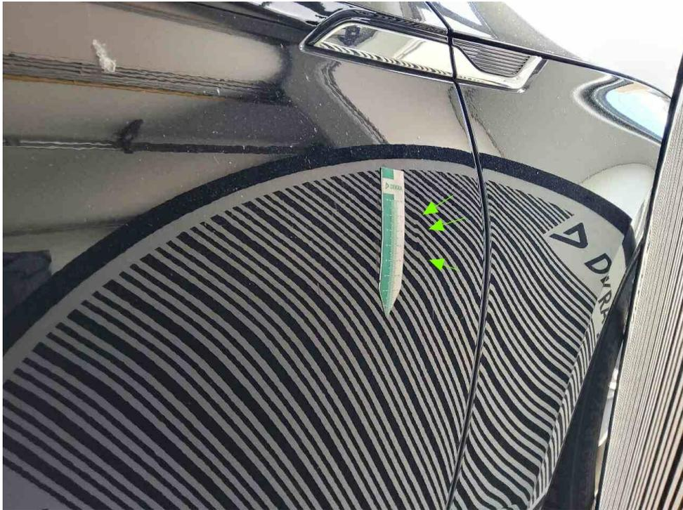
Bild 17 : zeigt den Schadenbereich Tür vorne rechts Delle
