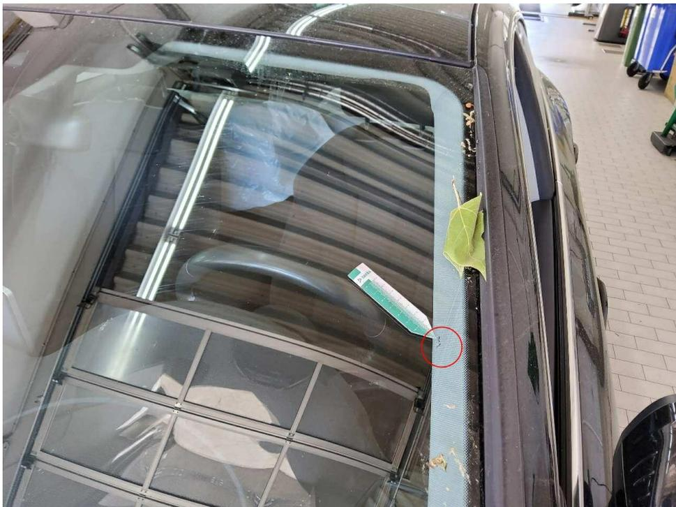
Bild 14 : zeigt den Schadenbereich Windschutzscheibe gerissen
