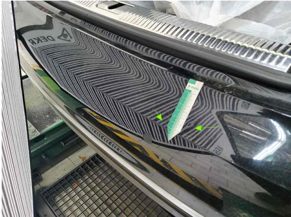
Bild 21 : zeigt den Schadenbereich Stoßfänger hinten mehrfach verschrammt
