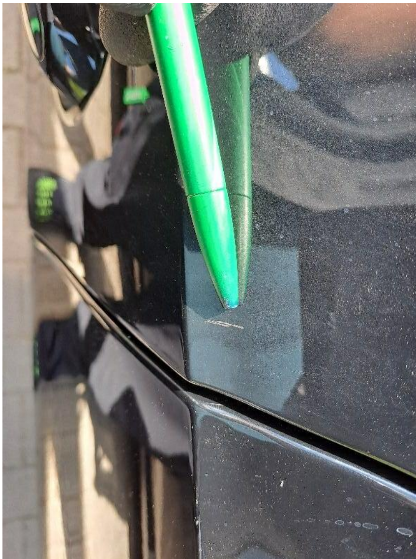
Bild 27 : Türe vorne links Kratzer
