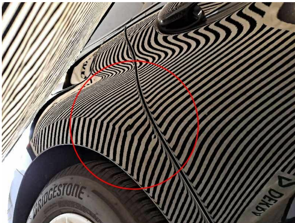
Bild 21 : Seitenwand hinten rechts Dellen
