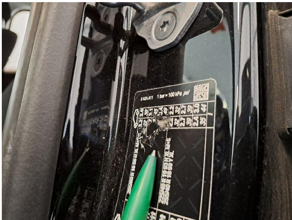
Bild 26 : Einstieg vorne links Kratzer + Delle
