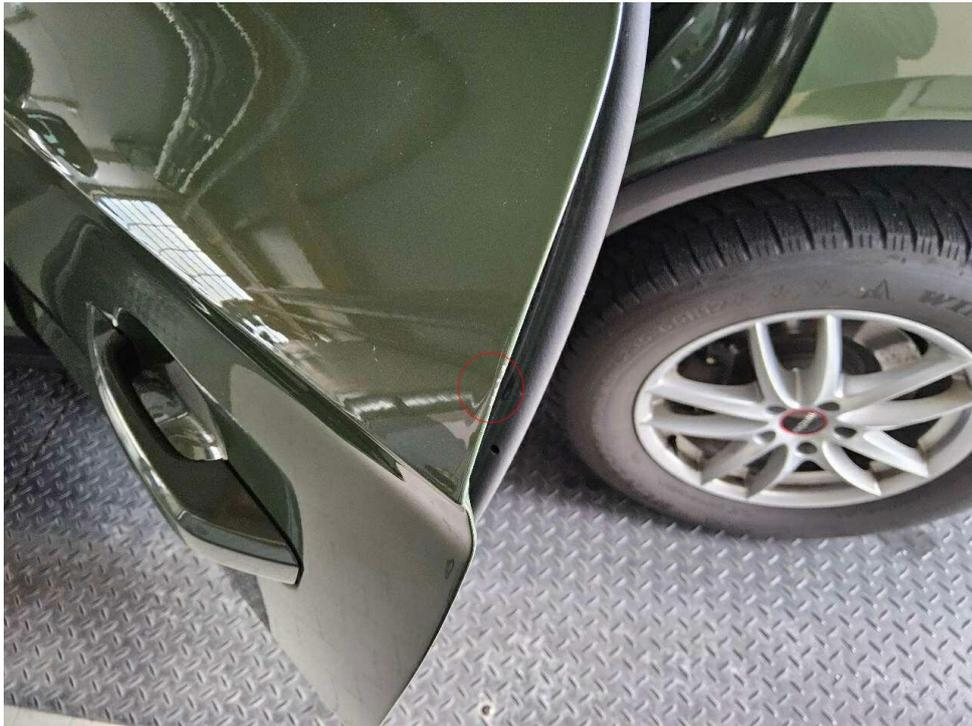
Bild 25 : Türkante hinten links kratzer
