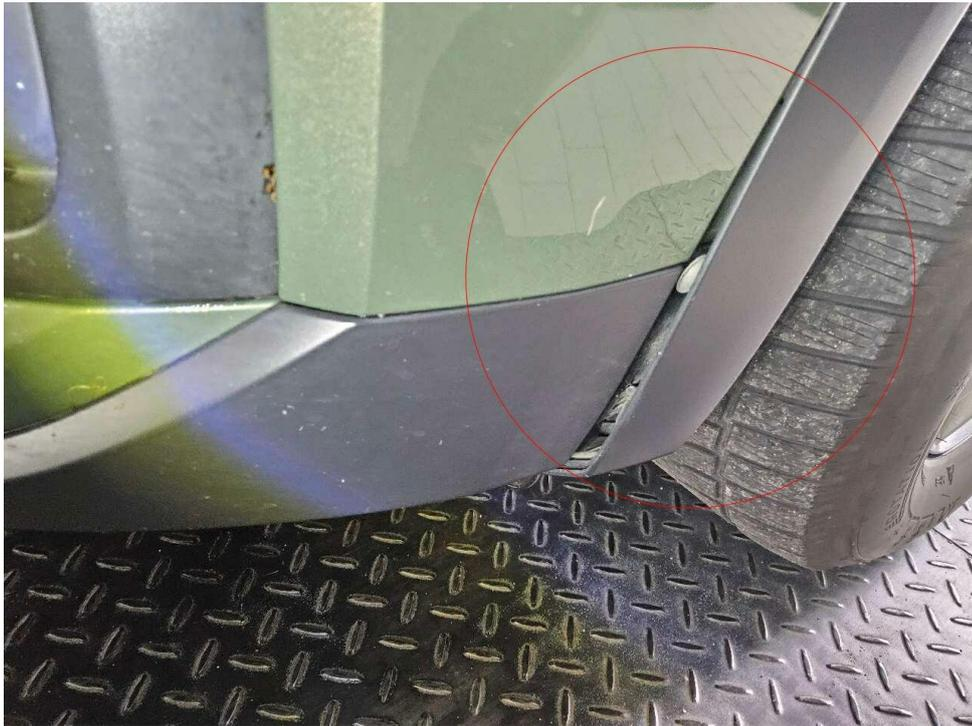
Bild 15 : Radlaufverbreiterung Lose
