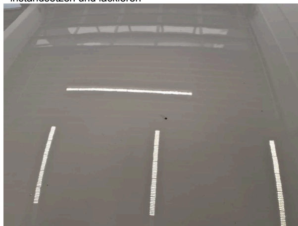
Beschädigung #7: Motorhaube: Motorhaube - verkratzt / verschürft - instandsetzen und lackieren
