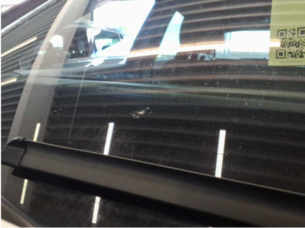
Beschädigung #8: Verglasung: Frontscheibe mit Regensensor - gebrochen / gerissen - erneuern
