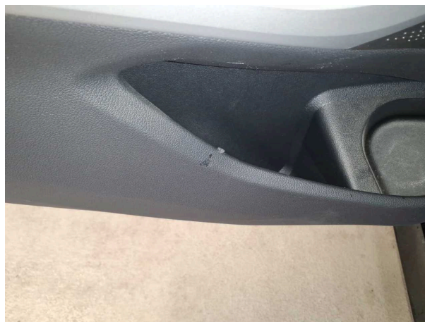
Beschädigung #2: Verkleidungen/Abdeckungen: Türverkleidung hinten links - beschädigt - Wertminderung
