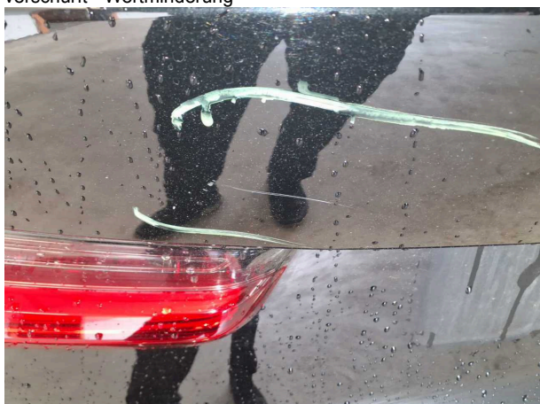
Beschädigung #4: Heckklappe/-tür: Heckklappe - verkratzt / verschürft - Smart Repair
