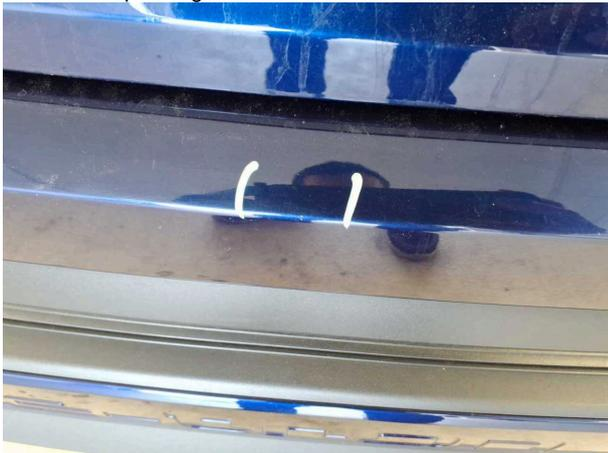
**Dommage #2:** Pare-chocs arrière: Pare-chocs arrière - Eraflé - Revêtement/polissage
