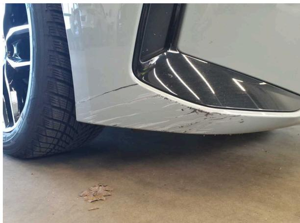
**Domage #2:** Pare-chocs avant: Pare-chocs avant - Eraflé - Réparer et repeindre
