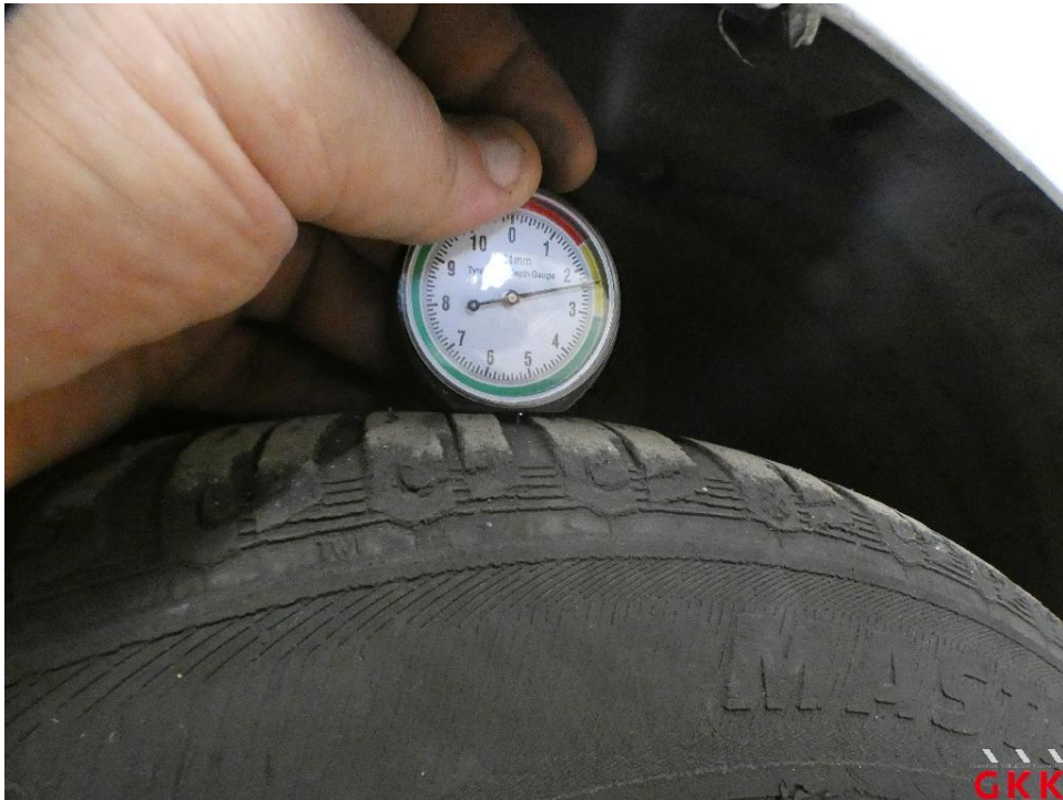
Bild 15 Reifen, vorne rechts, Untermaß, ersetzen
