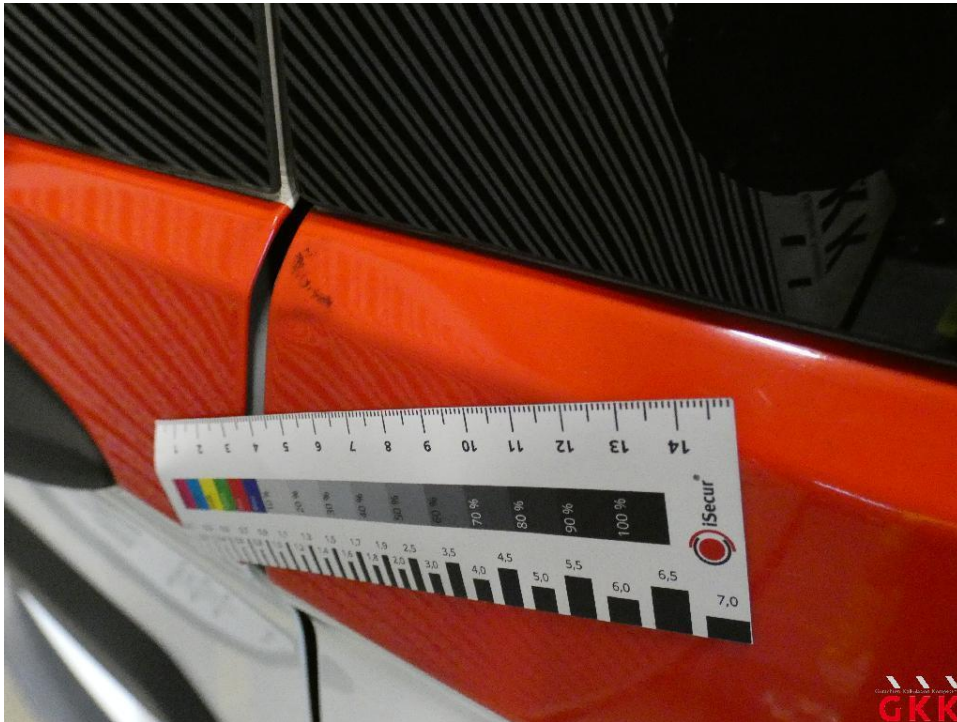
Bild 19 Hecktür rechts, oberhalb, beschädigt, instand setzen - lackieren
