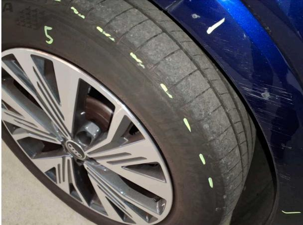
**Beschädigung #7:** Rad/Reifen: Reifen vorn - abgelaufen - erneuern
