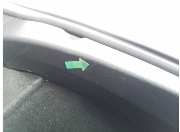
Beschädigung #1: Verkleidungen/Abdeckungen: Verkleidung Ladekante - verkratzt / verschürft - erneuern
