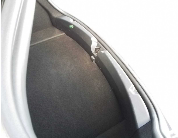
Beschädigung #1: Verkleidungen/Abdeckungen: Verkleidung Ladekante - verkratzt / verschürft - erneuern
