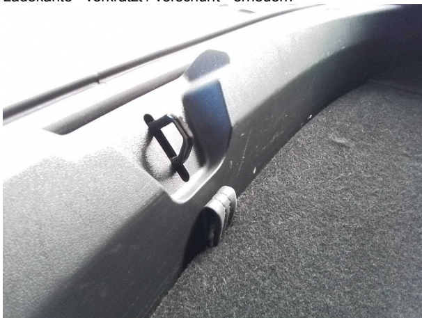
Beschädigung #1: Verkleidungen/Abdeckungen: Verkleidung Ladekante - verkratzt / verschürft - erneuern
