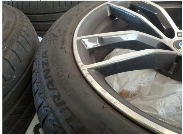
**Domage #2:** 2e Jeu de roues: 1 Jante alliage - Eraflé - Remplacer
