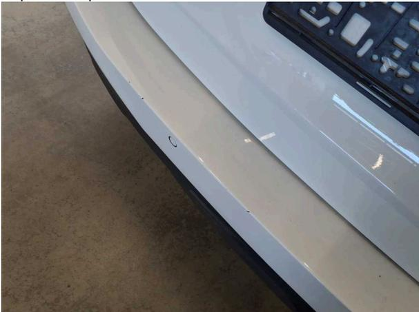
**Domage #1:** Pare-chocs arrière: Pare-chocs arrière - Eraflé - Réparer et repeindre
