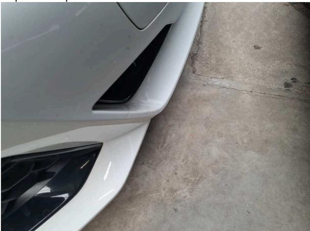
**Domage #3:** Pare-chocs avant: Pare-chocs avant - Déformé - Remplacer
