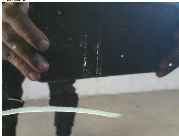
Domage #7: Porte AvD: Porte - Bosse, dommage peinture - Réparer et repeindre
