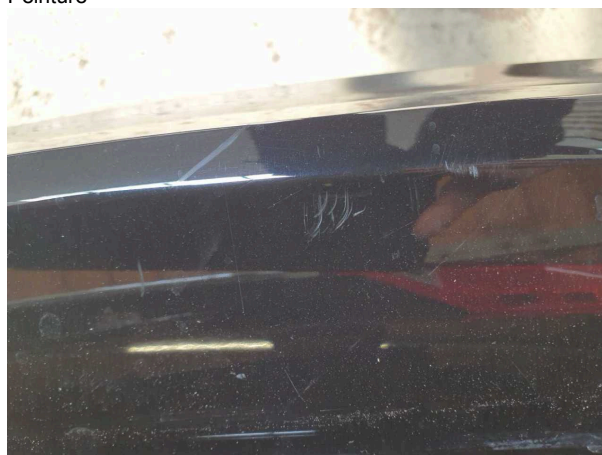
Dommage #6: Pare-chocs arrière: Pare-chocs arrière - Eraflé - Peinture
