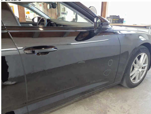
Domage #7: Porte AvD: Porte - Bosse, dommage peinture - Réparer et repeindre
