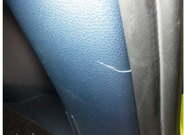
Beschädigung #1: Verkleidungen/Abdeckungen: Kofferraumverkleidung - verkratzt / verschürft - Smart Repair
