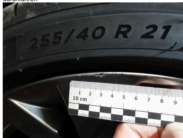
Beschädigung #5: Rad/Reifen: Leichtmetallfelge vorn links - Kratzer - Wertminderung
