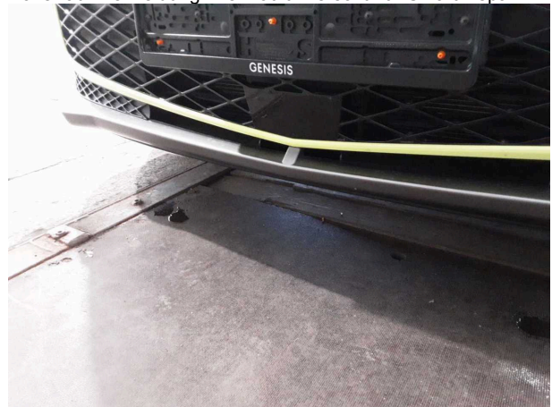
Beschädigung #2: Stossfänger vorn: Spoiler - Kratzer - Smart Repair
