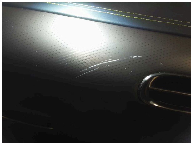
Beschädigung #3: Instrumententafel: Blende - Kratzer - erneuern
