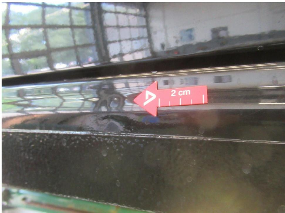
Bild 10 : Seitenschweller rechts, mehrfach eingedellt, instandsetzen und lackieren mit Lackaufbau - im Detail
