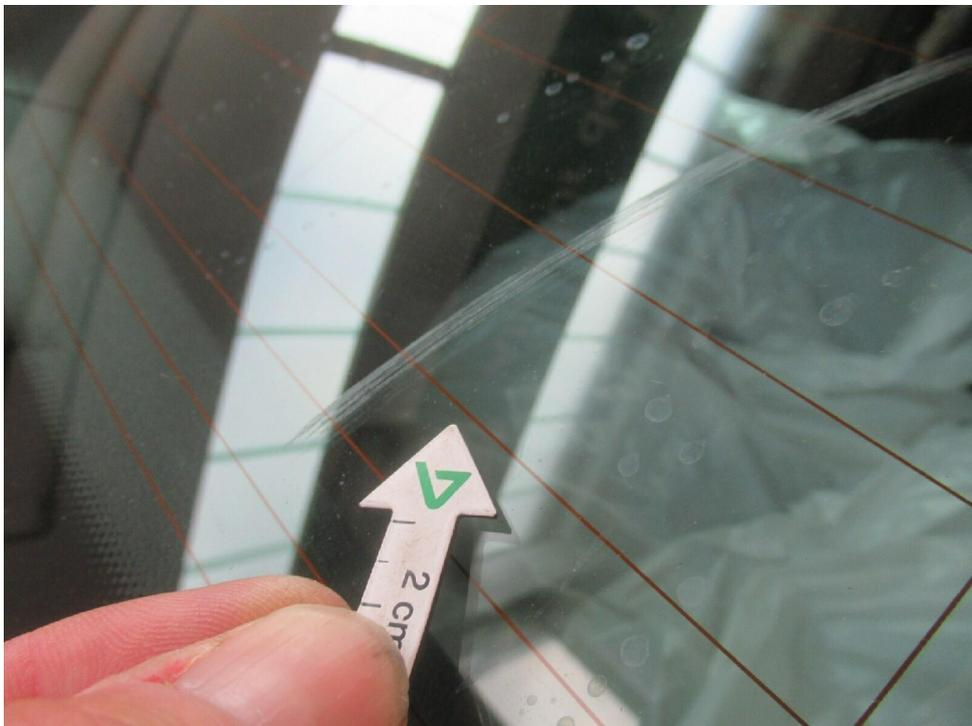
Bild 22 : Heckscheibe verkratzt
