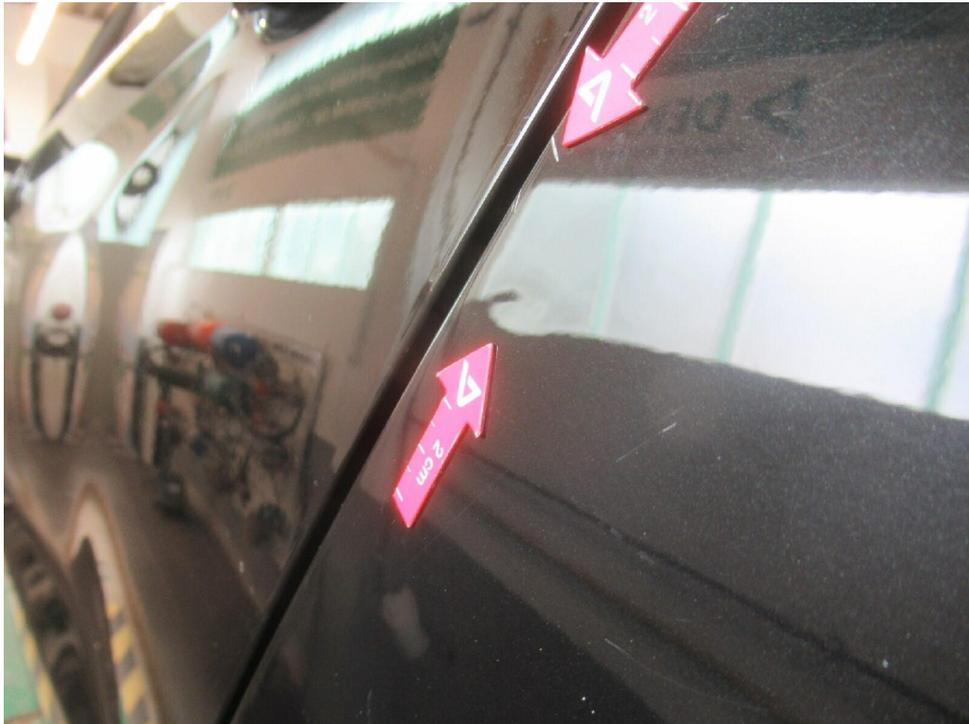
Bild 17 : Seitenteil hinten links, eingedellt und darüber verkratzt, smart repair
