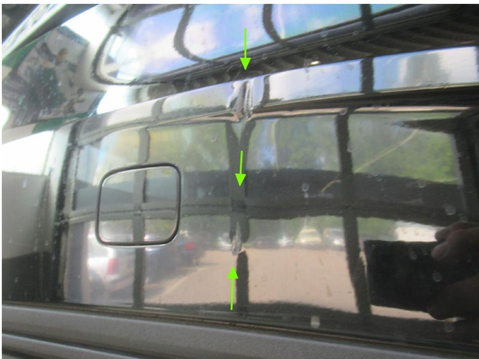
Bild 12 : Stoßfänger hinten rechts unfallbeschädigt
