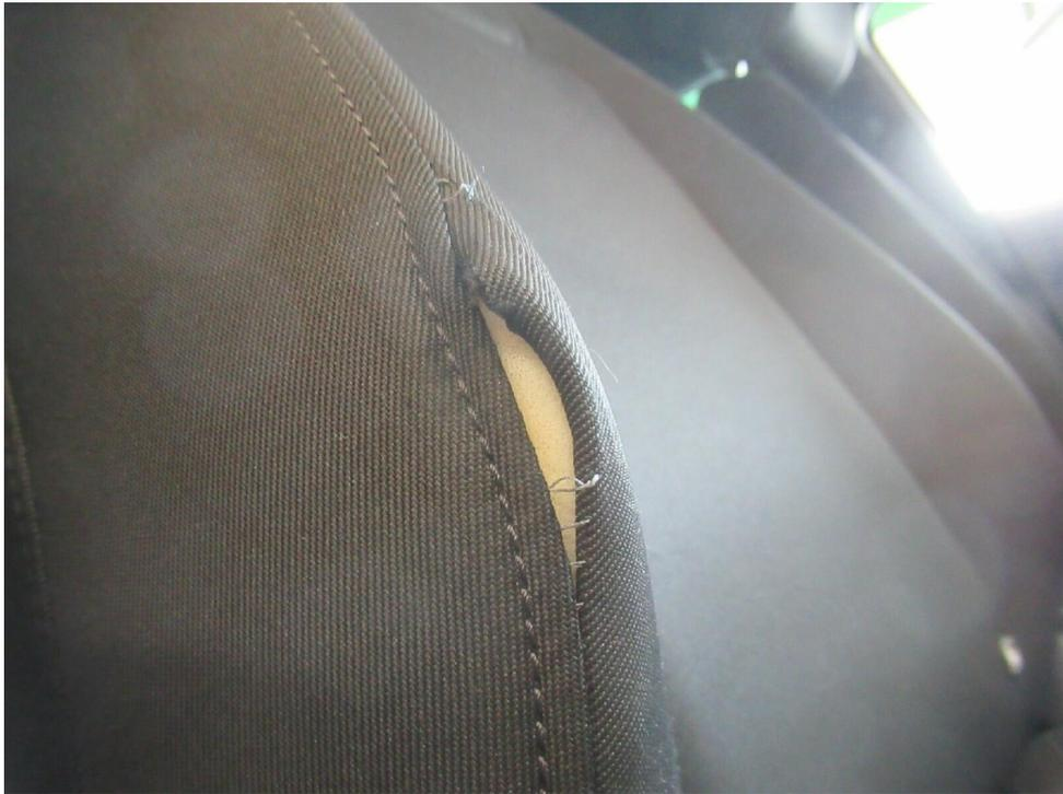
Bild 15 : Sitz vorne rechts Sitzlehnenbezug, Naht gerissen, smart repair
