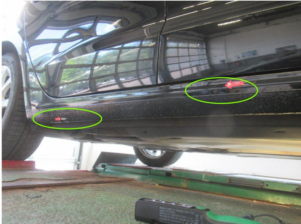
Bild 9 : Seitenschweller rechts, mehrfach eingedellt, instandsetzen und lackieren mit Lackaufbau
