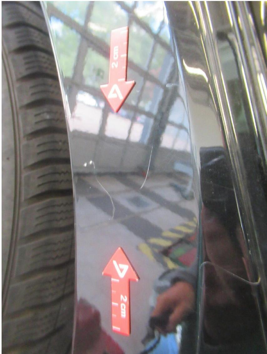
Bild 14 : Seitenteil hinten rechts Lackierung, zerkratzt, lackieren mit Lackaufbau - unterhalb
