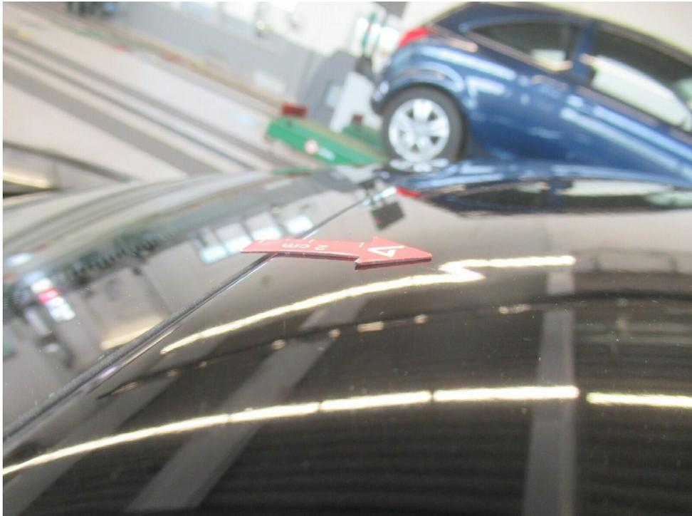
Bild 21 : Dach, mehrfach eingedellt, drücken - im Detail
