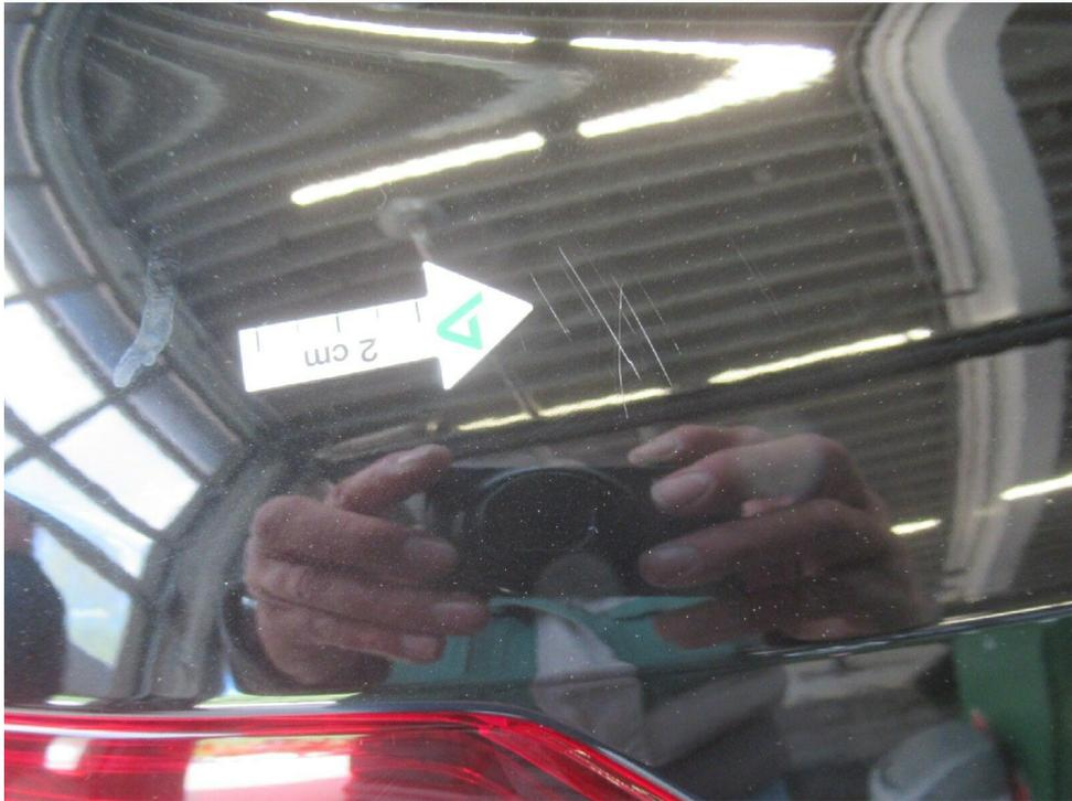
Bild 13 : Seitenteil hinten rechts Lackierung, zerkratzt, lackieren mit Lackaufbau - oberhalb
