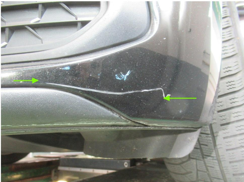
Bild 18 : Stoßfänger vorne links unterhalb Lackierung, zerkratzt, smart repair
