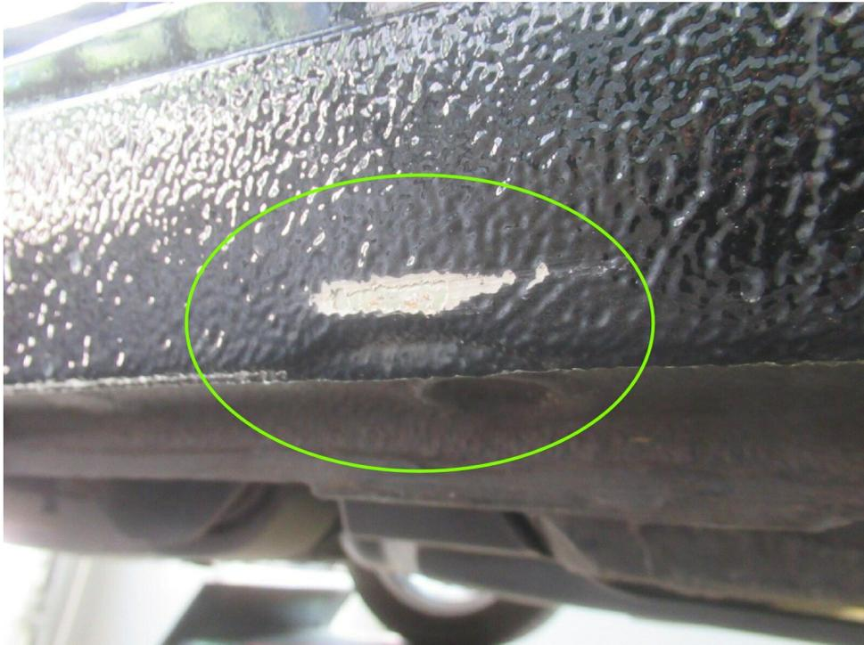
Bild 11 : Seitenschweller rechts, mehrfach eingedellt, instandsetzen und lackieren mit Lackaufbau - im Detail
