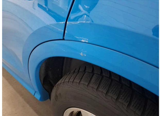
**Dommage #2:** Panneau latéral arrière gauche: Elargissement du passage de roue - Erafilé - Réparer et repeindre
