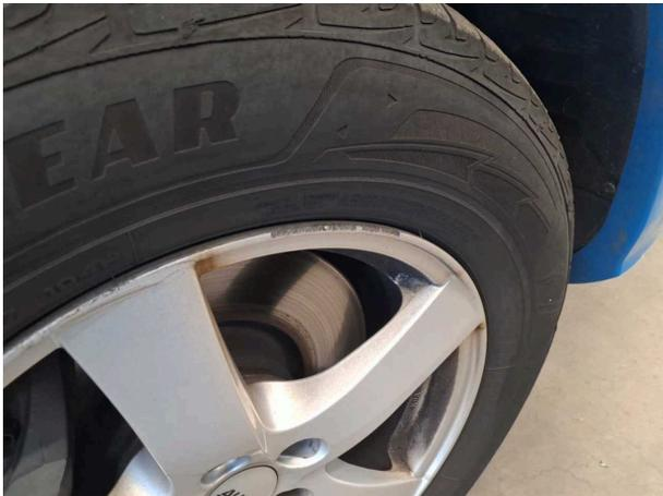
**Domage #12:** Roue / Pneumatiques: Jante alliage avant droite - Dommages - Remplacer
