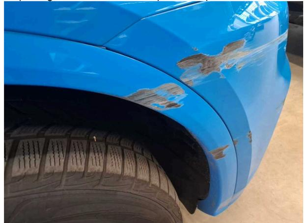
**Dommage #4:** Garde-boue droit: Elargissement du passage de roue - Erafilé - Remplacer
