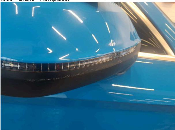
**Dommage #5:** Rétroviseur droit: Capuchon - Erafure - Remplacer
