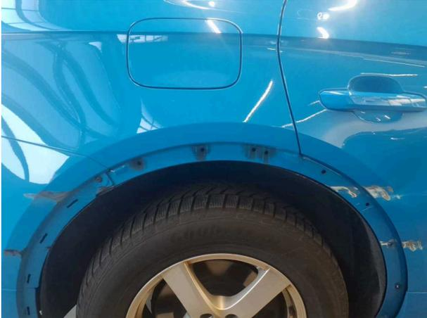
**Domage #6:** Panneau latéral arrière droit: Elargissement du passage de roue - Manquant - Remplacer
