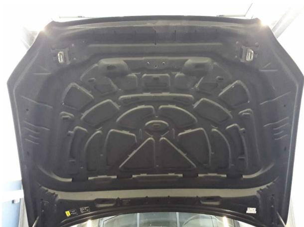
**Beschädigung #2:** Motorhaube: Dämmmatte - fehlt - erneuern
