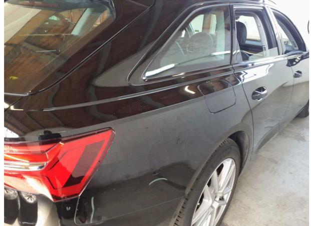
**Beschädigung #8:** Seitenwand rechts: Seitenwand - verkratzt / verschürft - lackieren
